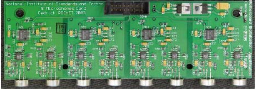
Şekil 2.7. NIST tarafından geliştirilen doğrusal mikrofon dizisi kartı
