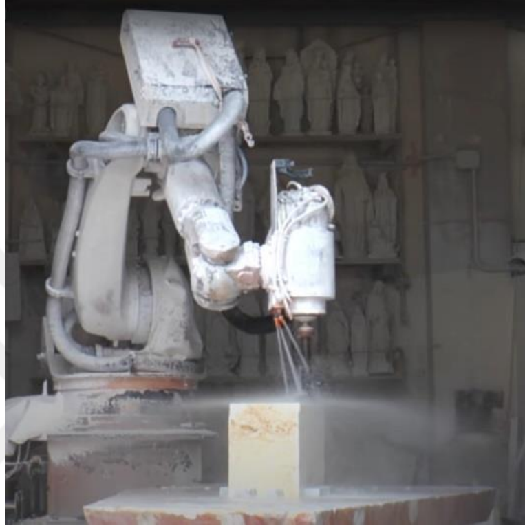
Görsel 10: CNC makine Taş malzeme işleme anından. The Restoration of - the sculpture of - Edward VII; Belgeselinden ekran görüntüsü(8:13)
