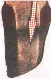
Şekil 8.25. Yanlış ısıt işlem sonucu oluşan derin çatlak.
