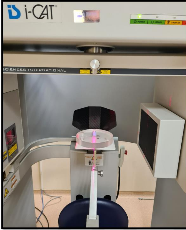
Şekil 3.12. CBCT Cihazına Yerleştirilmiş Model
