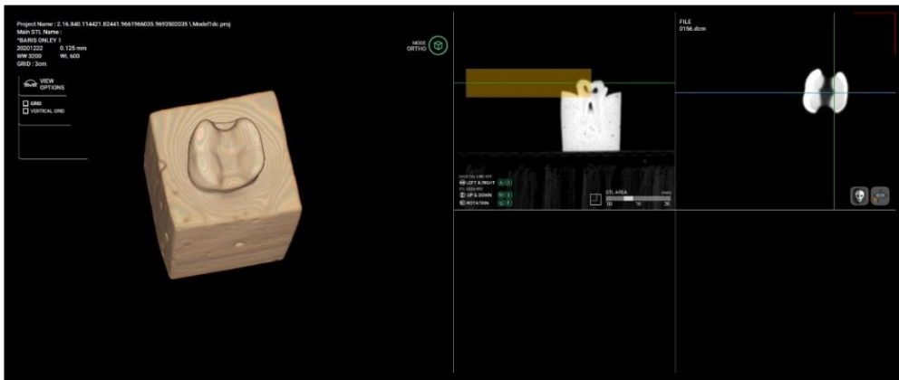
Şekil 3.13. CBCT Taraması Yapılan Örneğin 3 Boyutlu ve Kesitsel Görüntüleri
