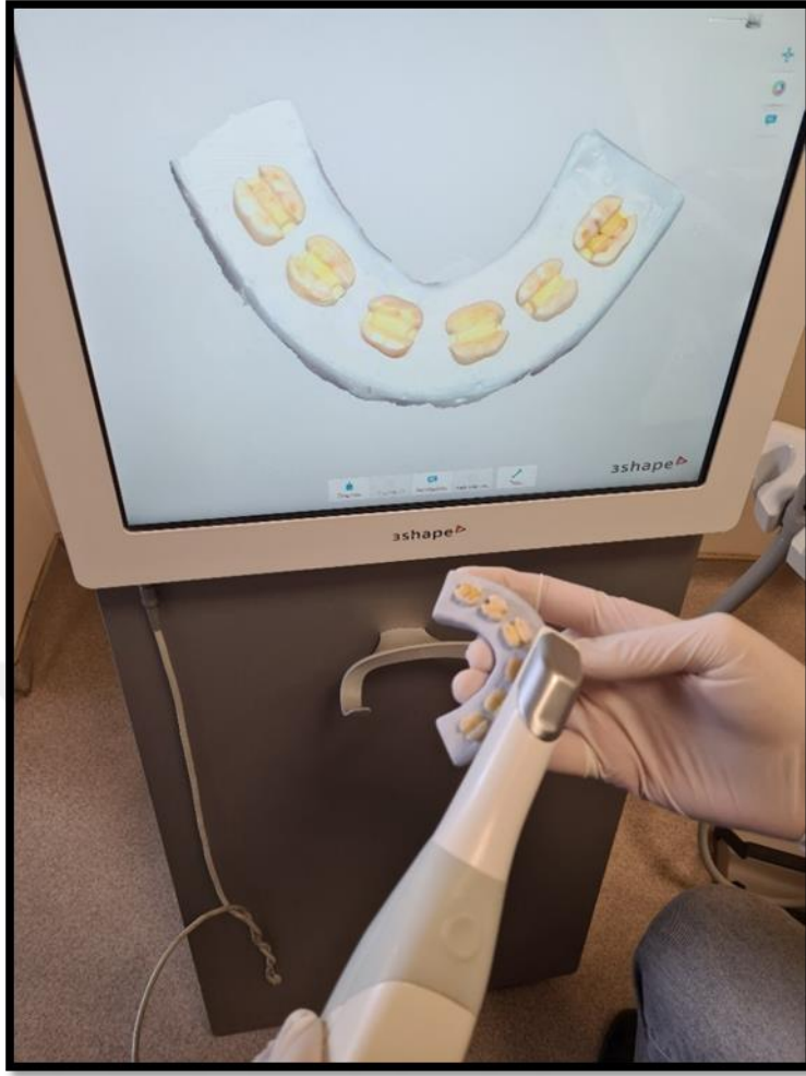
Şekil 3.11. 3shape Trios 3 Ağız içi Tarayıcı ile Taraması Yapılan Model
