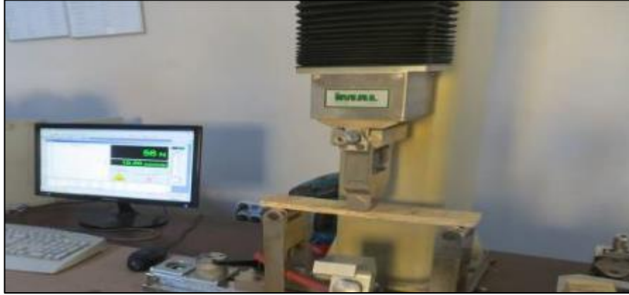
Fotoğraf 4.31 IMAL IB 600 Deney makinası eğilme direnci deneyi yapılması
