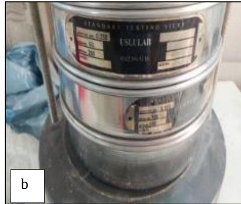
Fotoğraf 4.29 Willey değirmeninde öğütülen numunelerin titreşimli elekte elenmesi
