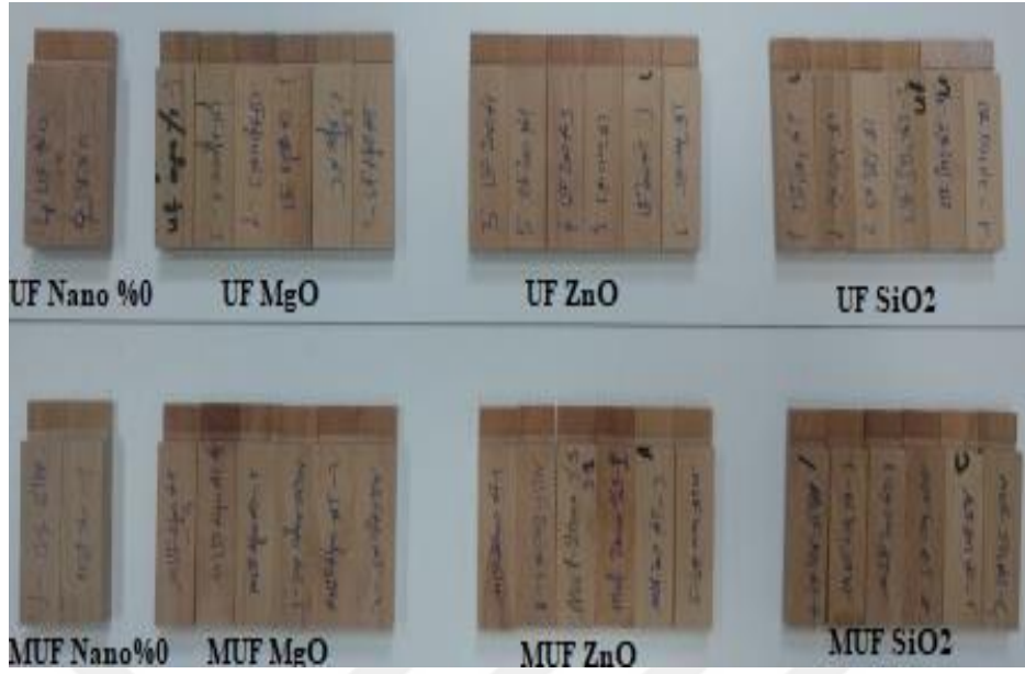
Fotoğraf 5.15 Çekme-Makaslama direnci deney numuneleri kopma şekilleri
