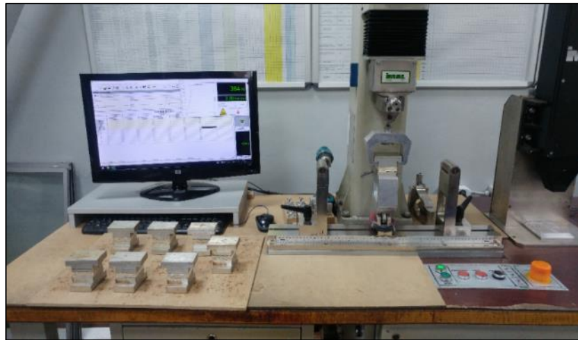
Fotoğraf 4.32 Yüzeye dik çekme deneyi için numunelerin takoza yapıştırılması (a), numunelere çekme deneyi uygulanması (b)
