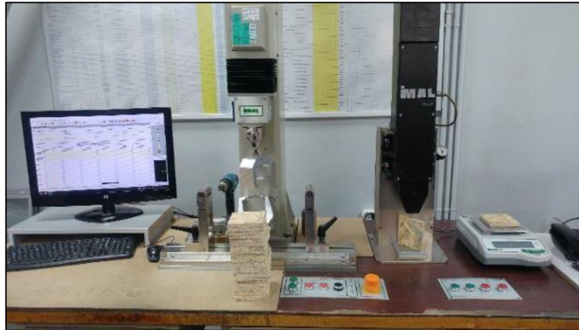
Fotoğraf 4.14 Birim hacim ağırlığı tayini için numune ebatlarının ölçümü
