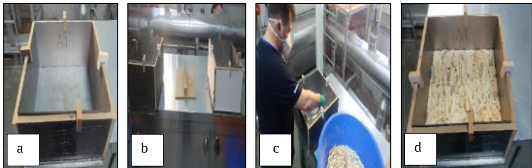
Fotoğraf 4.10 Serme kalıpları (a), (b), Şerit yongaların serme kalıbına serilmesi (c), (d)
