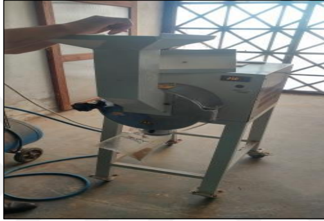
Fotoğraf 4.28 Willey değirmeninde numunelerin öğütülmesi
