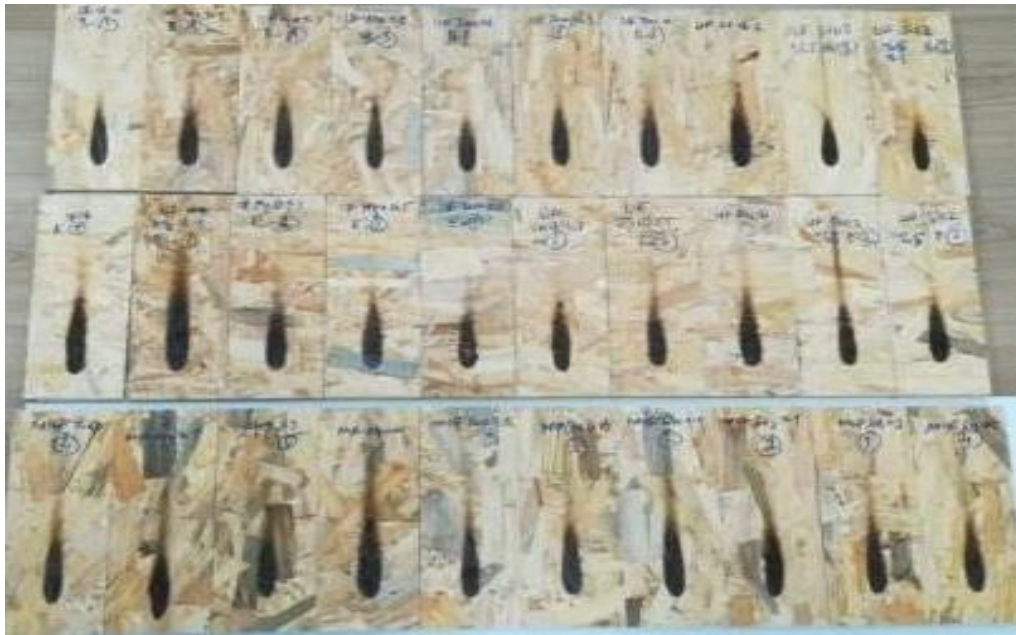
Fotoğraf 5.2 Yangına tepki deneyi yüzeyin aleve maruz bırakılması
