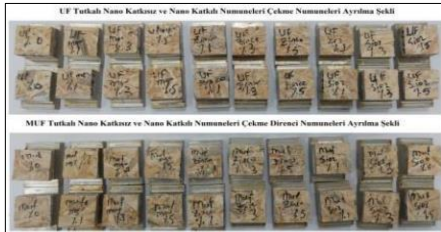
Fotoğraf 5.13 Çekme direnci deneyi numuneleri ayrılma şekilleri
