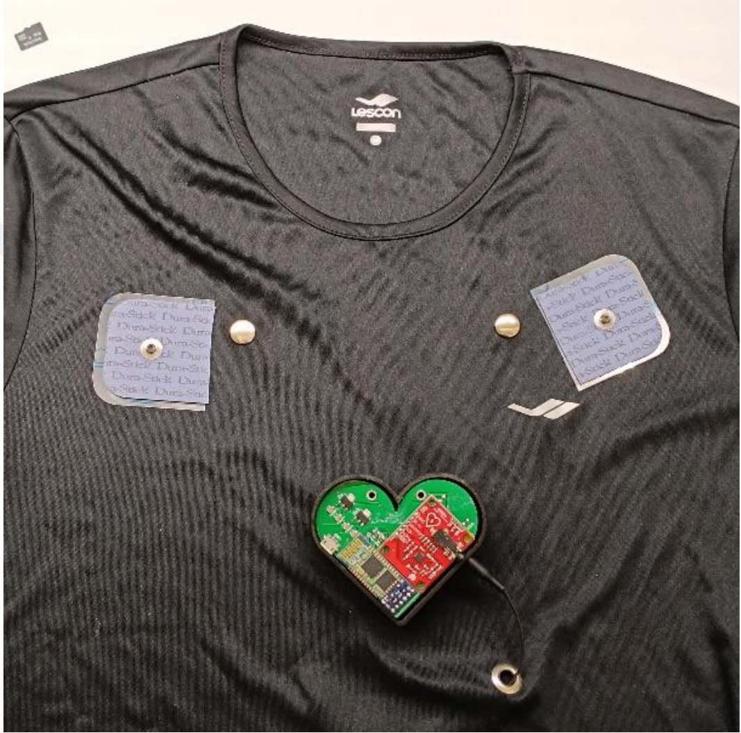
Şekil 3.11 Giyilebilir EKG T-Shirt Eelektroped Takılması
