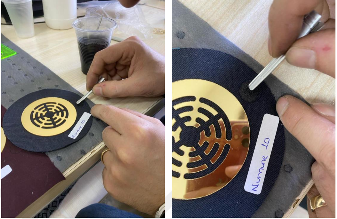
Şekil 3.13 İletken Mürekkebin Numunelere Uygulanışı
