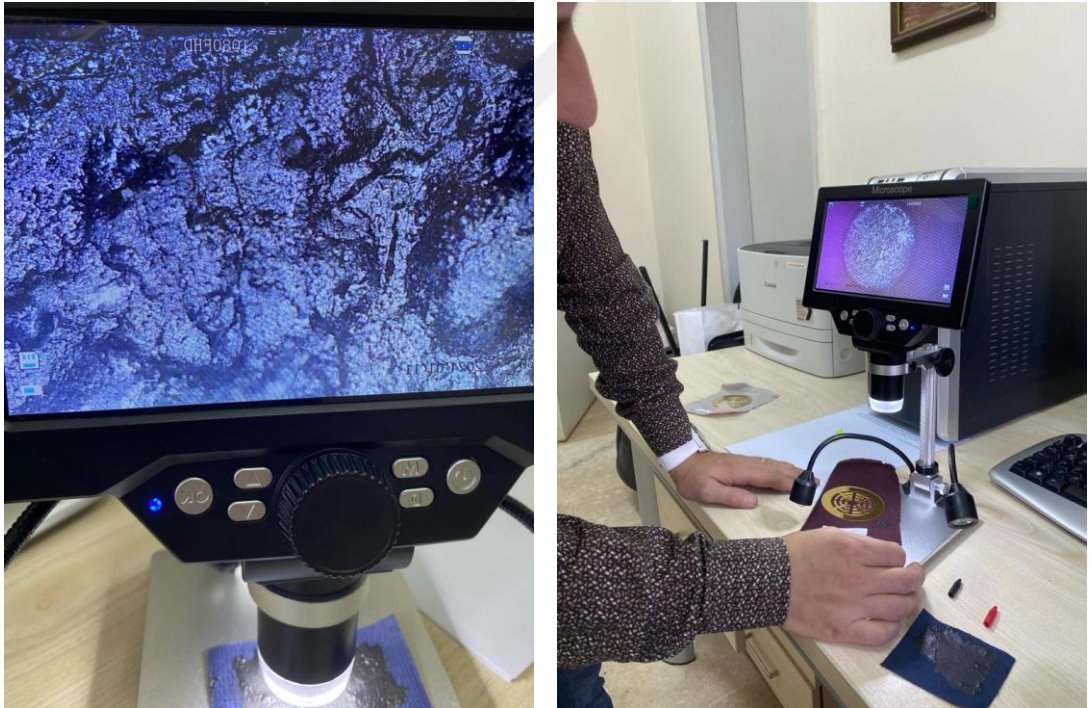
Şekil 3.14 İletken Mürekkepli Kumaşın Mikroskop Görüntüsü
