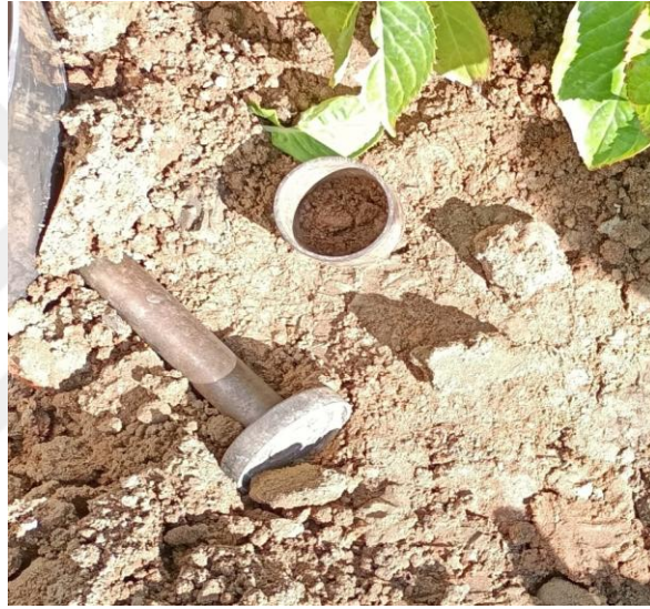
Şekil 3.15. Bozulmamış toprak örneği alma kabı ve çakma plakası
