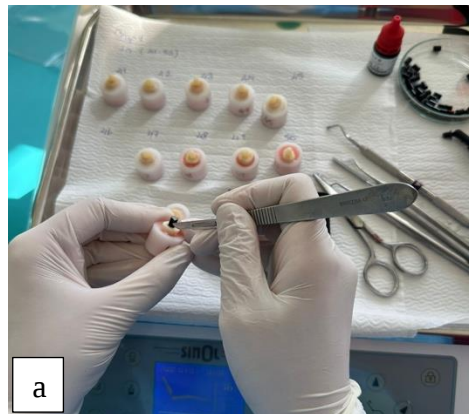
Resim 25. (a) Restoratif Materyal Uygulaması Sonrası Kullanılan Plastik Kalıbın Kesilerek Çıkartılması (b) Restoratif Materyal Uygulaması Sonrası Örneklerin Görüntüsü
