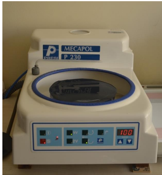
Resim 6. Zımpara-Polisaj Cihazı (Mecapol P 230, PRESI, Fransa)
