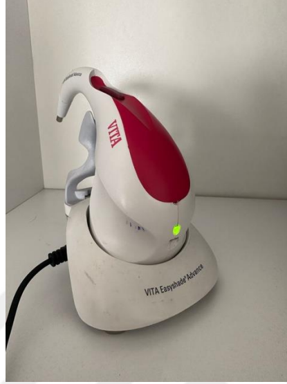
Resim 18. VITA Easyshade Advance 4.0 Spektrofotometre (VITA-Zahnfabrik, Bad Säckingen, Almanya)
