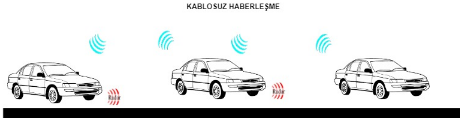
Şekil 2.7 Kooperatif adaptif seyir kontrol sistemi
