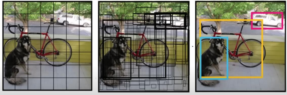
Şekil 3.6 YOLO tek aşamada nesne tespit işlemi (Redmon vd., 2016)
