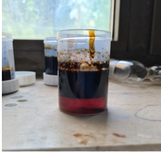
řekil 2.9. Karbonizasyon sonucu kondenser kullanılarak elde edilmiř olan piroliz sıvısı
