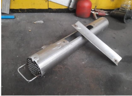
Şekil 2.12. Tasarlanıp üretilen 310 paslanmaz çelik tüp
