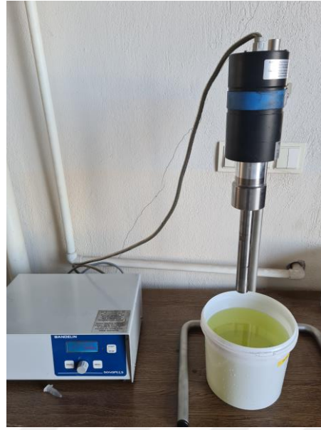
Şekil 2.38. Yakıt karışımı hazırlanan sonikatör
