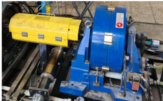
Şekil 2.46. Eddy akım dinamometre sistemi
