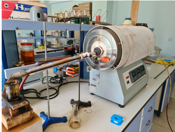
Şekil 2.11. Yüksek sıcaklık fırını (inert ortam)
