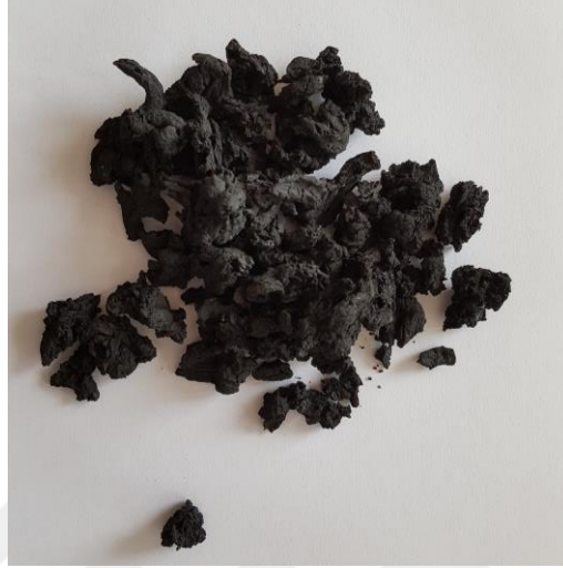
Şekil 2.14. Aktif karbon (fiziksel aktivasyon)
