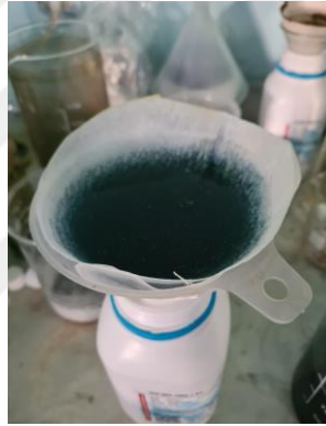
Şekil 2.23. Aktif karbon yıkama ve çözelti süzme işlemi
