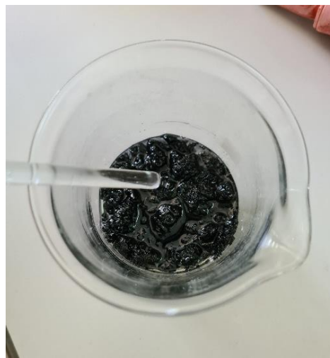
Şekil 2.17. ½ Oranında KOH karışımı karbonlaşmış AÇ
