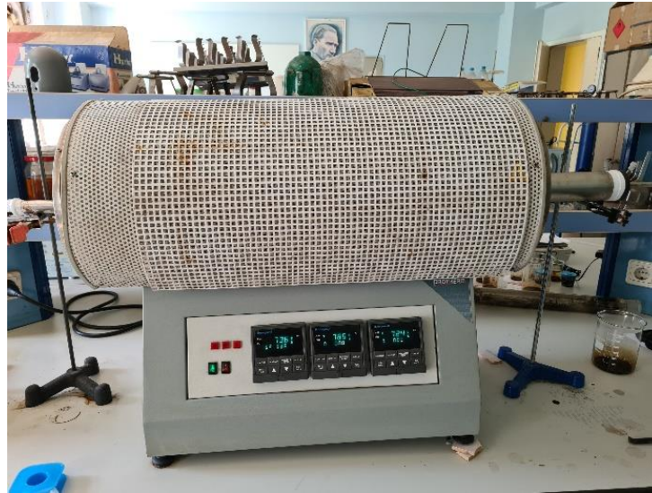
Şekil 2.5. Karbonizasyon deney düzeneği-2
