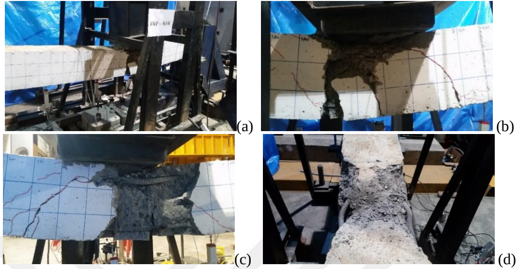
Şekil 4.31 : Imp-H450 kolon numunesine ait deney sonrası hasar fotoğrafları, (a) güney cephe genel görünümü, (b) güney cephe darbe bölgesi çevresi, (c) kuzey cephe darbe bölgesi çevresi, (d) darbe uygulanan kenar görünümü.
