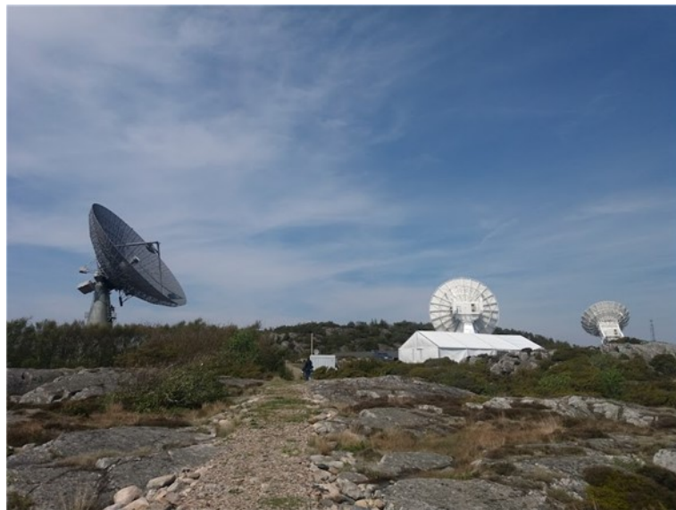
Şekil 3. Onsala Uzay Gözlemevi (İsveç)'ndeki uzay jeodezik gözlemlerine yönelik ekipmanlar: 25 metre radyo teleskop ve 13,2 m ikiz teleskoplar
