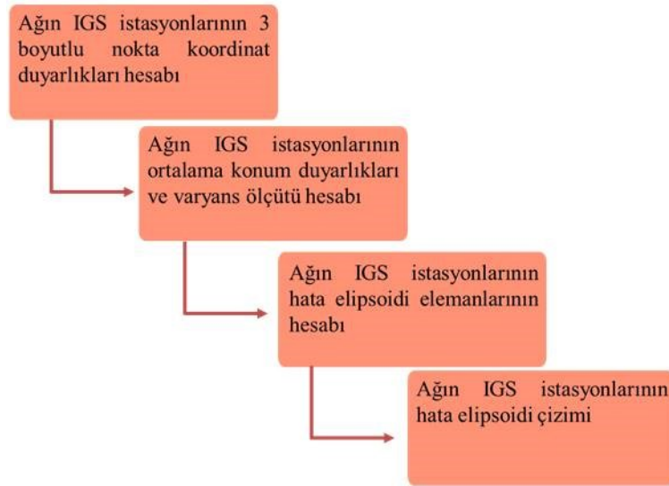
Şekil 12. Ağlar için hesaplanan duyarlık ölçütlerinin iş akış şeması
