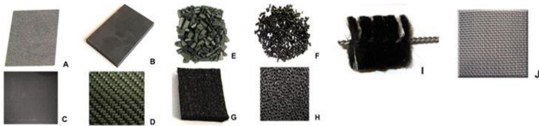
Şekil 1.1. Mikrobiyal yakıt hücrelerinde kullanılan bazı elektrot malzemeleri: (A) karbon kağıdı; (B) grafit levha; (C) karbon bezi; (D) karbon örgü; (E) tanecikli grafit; (F) taneli aktif karbon; (G) karbon keçe; (H) ağsı vitrifiye karbon; (I) karbon fırçası; (J) paslanmaz çelik örgü [8]
