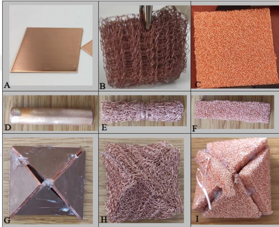
Şekil 4.13. Deneysel elektrotlar, A) plaka geometrili levha yapılı, B) plaka geometrili ağ yapılı, C) plaka geometrili köpük yapılı, D) silindir geometrili levha yapılı, E) silindir geometrili ağ yapılı, F) silindir geometrili köpük yapılı, G) piramit geometrili levha yapılı, H) piramit geometrili ağ yapılı, I) piramit geometrili köpük yapılı elektrot.
