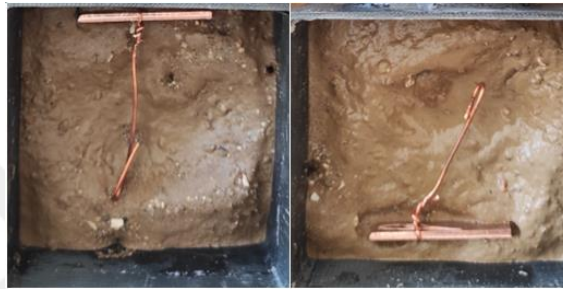
Şekil 4.14. Mikrobiyal yakıt hücresi elektrot konumu konfigürasyonu elektrot pozisyonları
