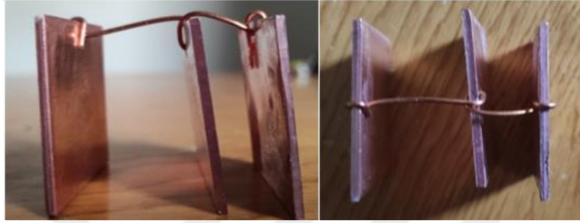
Şekil 4.16. Mikrobiyal yakıt hücresi elektrot adedi konfigürasyonu elektrotları 3 adet elektrot.
