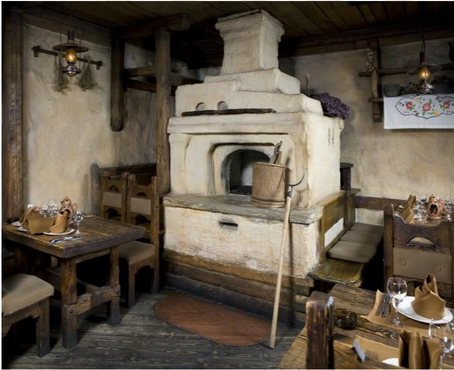
Şekil 2.6: Rusya'da 16. yüzyıla ait bir fırın- soba örneği. Arkada duvara dayalı bölümünde uyku yeri vardır. Uyku yeri genellikle, ısınan havanın yükselmesi prensibine bağlı olarak havanın en sıcak olduğu, tavana yakın yerde oluyordu. Genellikle sobaların içinde mantar ya da ot kurutmak, dışında ise giysi ya da ayakkabı koymak için kullanılan küçük nişler bulunuyordu.
