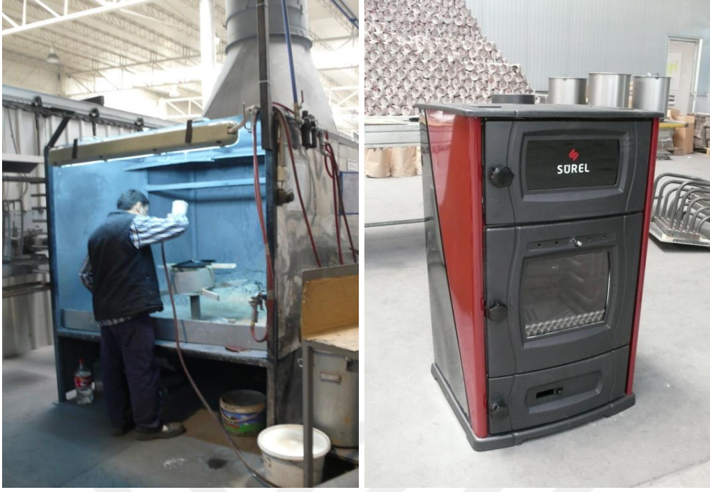
Şekil 3.72: Ata Döküm Firmasına ait tesiste pres ve kesim makineleri ile imal edilmiş soba parçaları üzerine emaye kaplamanın yapıldığı ünite ve bitmiş ürün örneği olarak emaye kaplamalı pik döküm şömine tipi Sürrel odun-kömür sobası. 2013. Fotoğraf: Candan Sezgin
