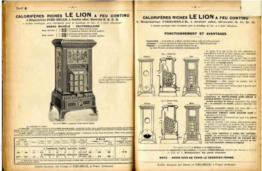
Şekil 3.12: Kömür yakıtlı bir demir sobanın verimli ve güvenli yanmasını temin etmek üzere soba gövdesine yerleştirilmiş havalandırma boşluğunu ve teknik çizimini gösterir katalog sayfası
