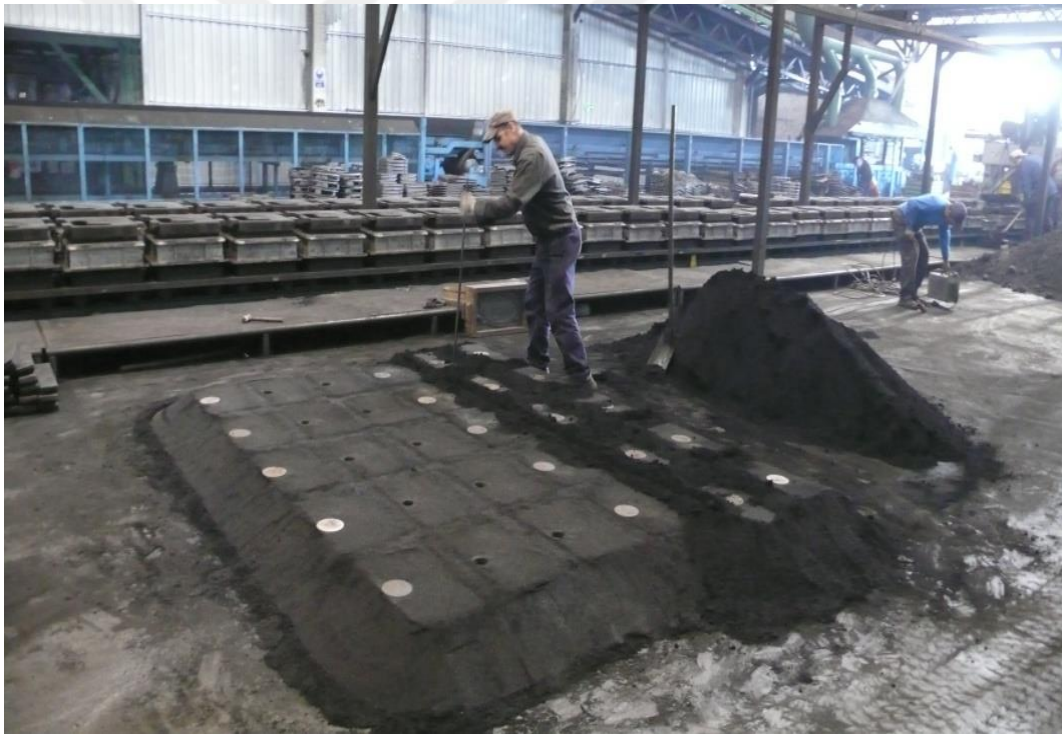
Şekil 3.71: Eskişehir’de, Ata Döküm Firmasına ait tesiste, firmanın tescilli markası olan Sürel sobalarında kullanılmak üzere ergitilen demirin kum kalıplara dökülmesiyle soba parçası hazırlanması. 2013. Fotoğraf: Candan Sezgin
