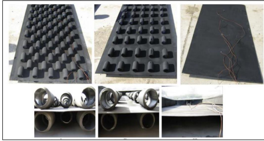
Şekil 3.1. Çalışmada yer alan kolektörlerin emici yüzey geometrileri
