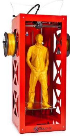
Resim 117. FDM tekniğiyle baskı yapan bir 3B yazıcı ve içinde çıktı obje (Uygan, 2016: Görsel 19)
