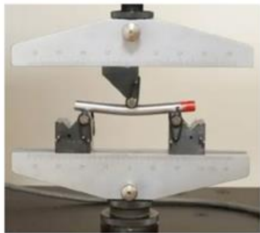
Resim 113. Solda modulus testi ve sağda bükülme testi.
