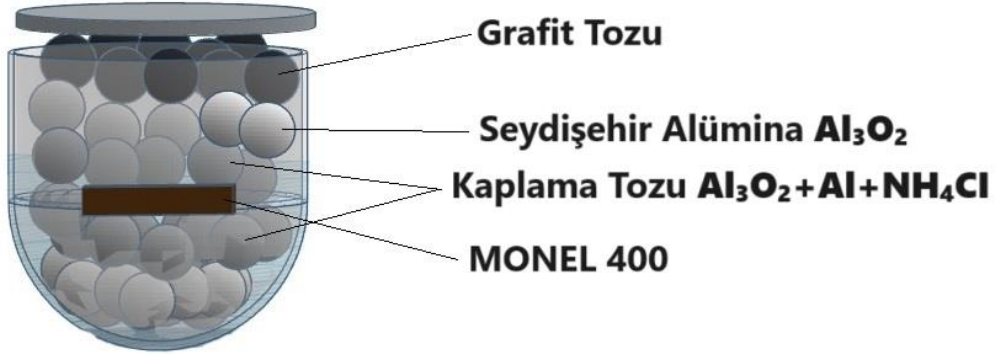
Şekil 5.2. Pota içerisine koyulan tozların ve numunenin şematik gösterimi.
