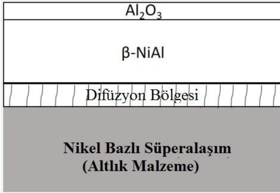
Şekil 3.1. Alüminyumlanmış süper alaşım üzerinde koruyucu Al_2O_3 tabakasının oluşumunun şematik gösterimi [28].
