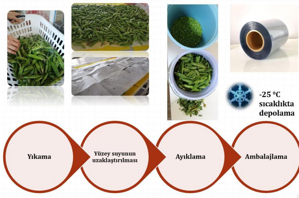
Şekil 4. 22 Bezelye Kabuklarına Uygulanan Ön İşlem Adımları
