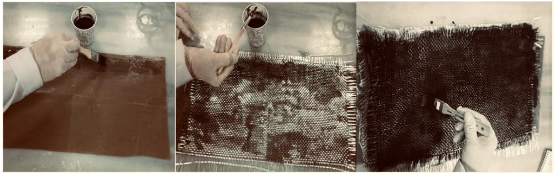
Şekil 12. Fırçalama işlemi ve elyaf yatırma
