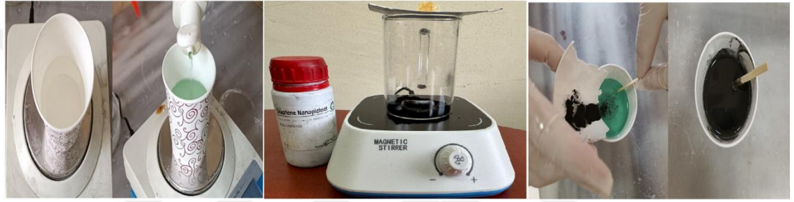
Şekil 11. Nano-grafen parçacık takviyeli reçine/sertleştirici polimerik sisteminin hazırlanışı
