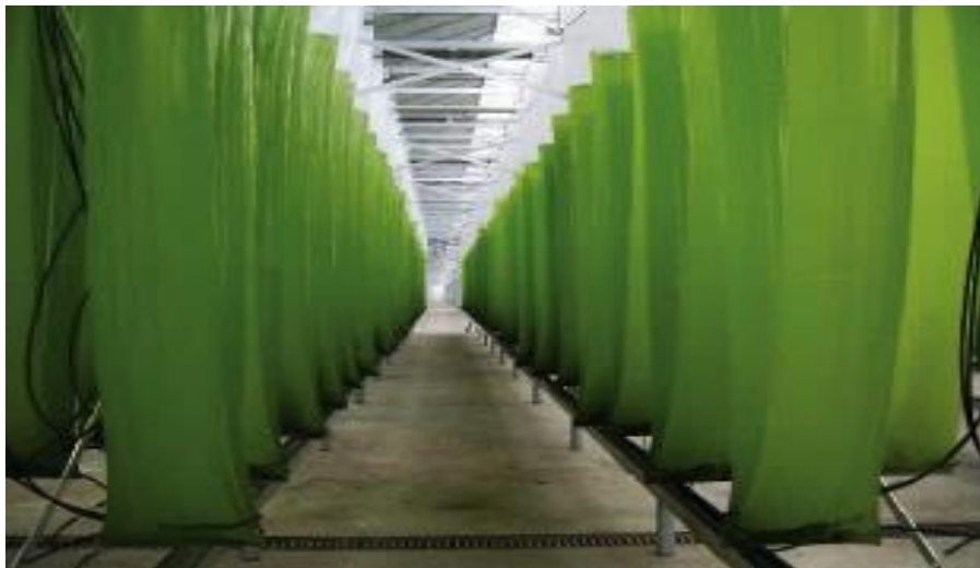
Görsel 2.4. Plastik torbalı fotobiyoreaktör sistemi (Placzek vd., 2017)
