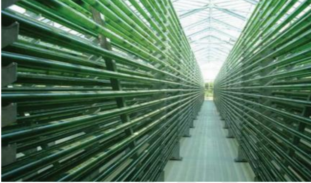
Görsel 2.2. Tübüler yapıli fotobiyoreaktör sistemi (Kargin, 2020)
