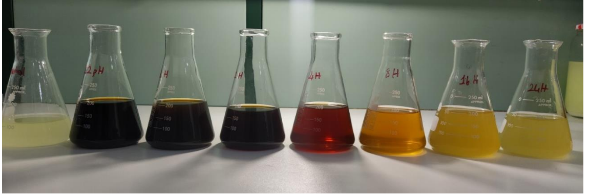
Şekil 4.4. pH 12 değerinde enolizasyon işlemine tabi tutulmuş loraltı sularına farklı sürelerdeki mikro/nano ozon gazı kabarcığı uygulaması ( \mu/\eta\text{O}_3 ), sonucu elde edilen renk değişimleri.
