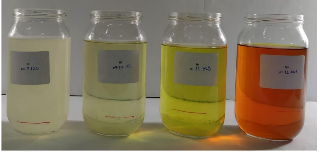
Şekil 4.2. Loraltı suyuna NaOH ilavesinden 12 saat sonraki oluşan renk değişimi
