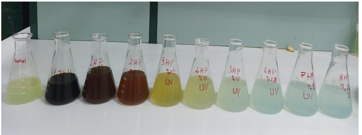
Şekil 4.6. pH 12 değerinde enolizasyon işlemine tabi tutulmuş loraltı sularına farklı sürelerdeki mikro/nano ozon gazı kabarcığı+hidrojen peroksit+ultraviyole-C ( \mu/\eta\text{O}_3+\text{H}_2\text{O}_2+\text{UV-C} ) uygulaması sonucu elde edilen renk değişimleri.
