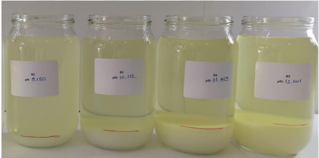
Şekil 4.1. Lor altı suyuna NaOH ilavesi sonrası oluşan çökelti.
