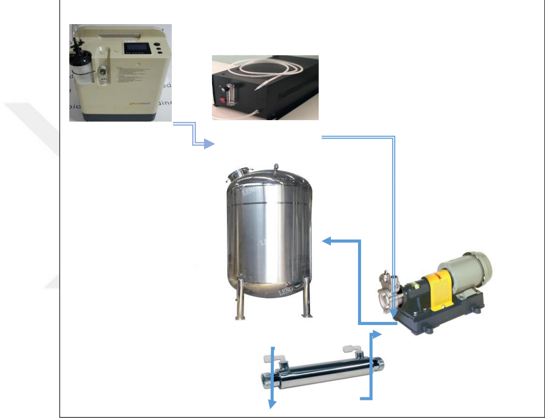
Şekil 3.2. Ultraviyole ışığı düzeneği bağlanmış mikro/nano ozon kabarcık jeneratörü.
