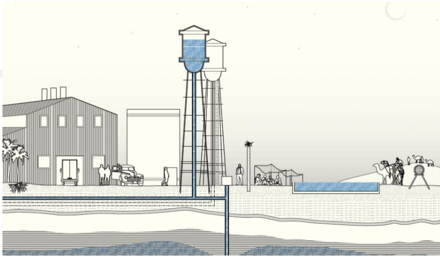
Şekil 3.3.2 : Aramco kuyularından su oluklarına su akışını gösteren kesit çizimi. (Ghosn&Jazairy, 2018).
