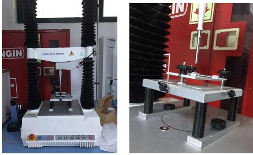
Şekil 3.10 Tekstür cihazı ve şekerleme tutucu tablası
