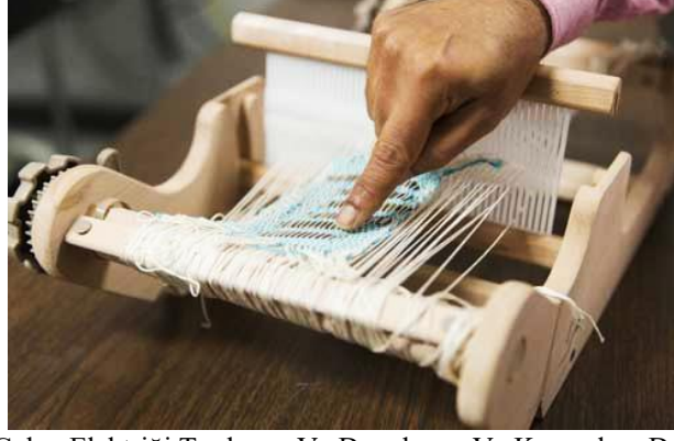
Şekil 2.12. Güneşten Gelen Elektrikçi Toplayan Ve Depolayan Ve Kumaşlara Dokunabilen İnce, Esnek, Hafif Bir İplik
