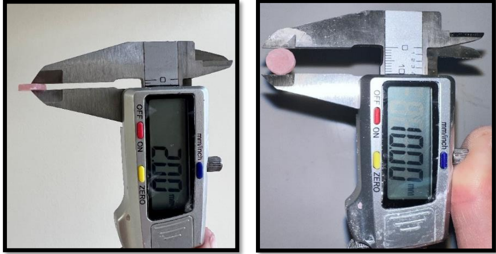
Şekil 3. 10: Örneklerin boyutunun dijital kumpas ile ölçümü
