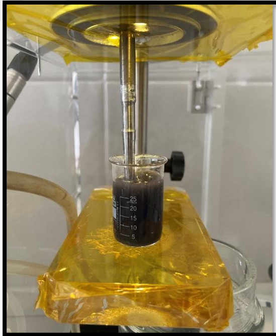
Şekil 3. 4: Gümüş nanopartiküllerinin monomer içerisinde ultrasonik cihazla homojenizasyonunun sağlanması
