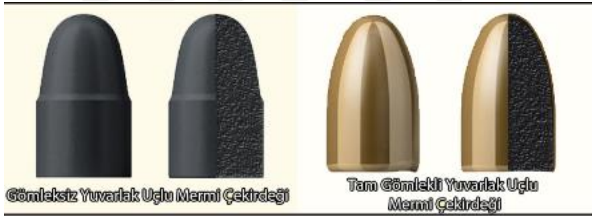
Resim 7. Gömlekli ve gömleksiz çekirdekler (36).
