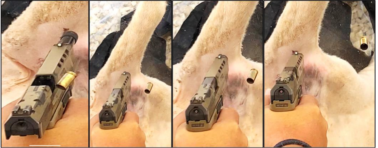
Resim 2: Kovanın yarı otomatik tabancadan dışarı atılması.
