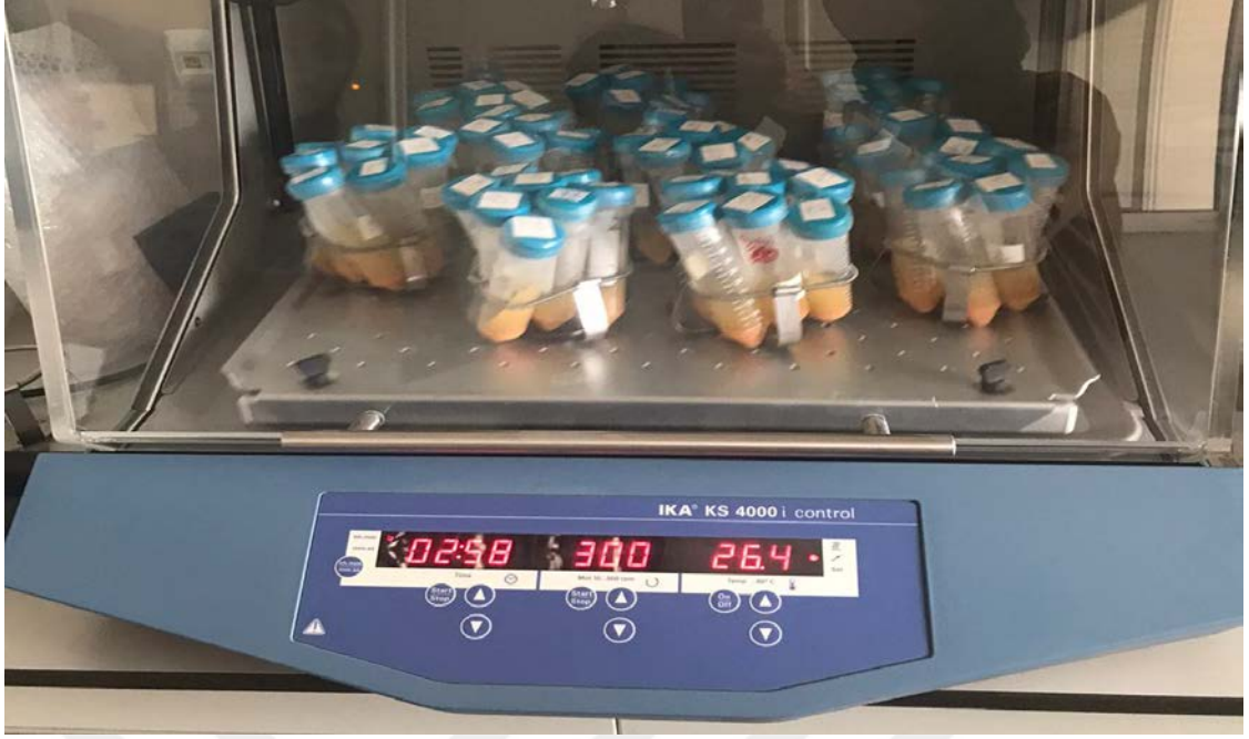
Şekil 3.22. Ekstraksiyonların hazırlanma aşamasında orbital çalkalayıcıda bekletilen numunelerin homojenizasyonunun sağlanması
