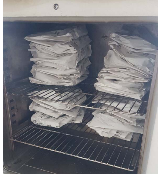
Şekil 3.17. Bitki besin elementi içeriklerinin tespit edilmesi için toplanan bitki örneklerinin etüvde kurutulması
