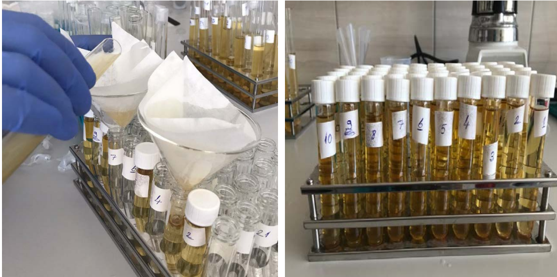
Şekil 3.21. Mercimek tanelerinde toplam antioksidan madde tayini ve fenolik bileşiklerin tespiti için ekstraksiyonların hazırlanma aşaması
