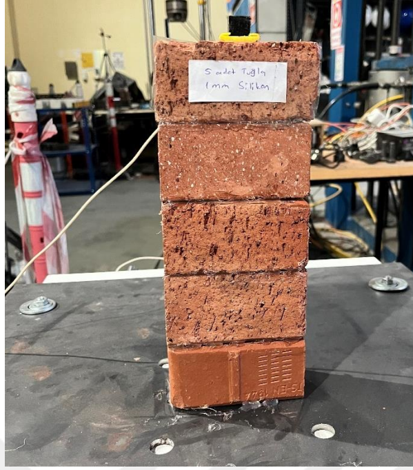
Şekil 3.17 5 adet harman tuğlası – 1 milimetre silikon doğal frekans deneyi
