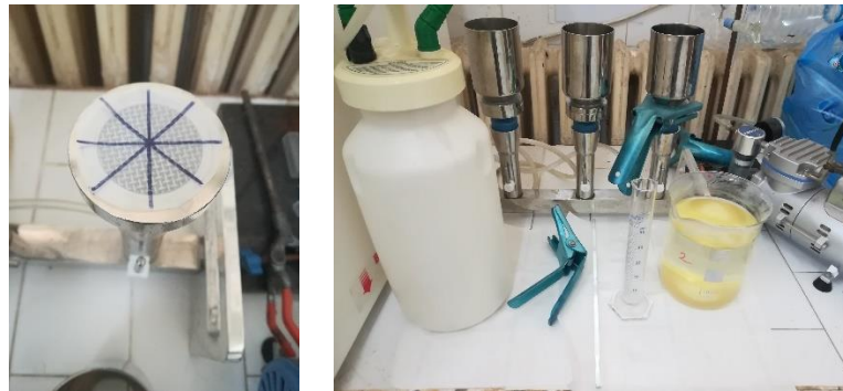
Şekil 2.12 Naylon filtre ve vakum pompası
