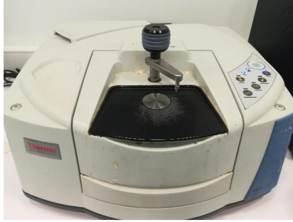
Şekil 2.17 Thermoscientific marka ve model Fourier dönüşümlü kızılötesi spektroskopisi (FTIR) cihazı
