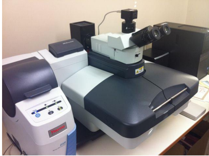
Şekil 2.16 RAMAN Cihazı (Thermo – DXR Raman) (NABİLTEM, 2024)
