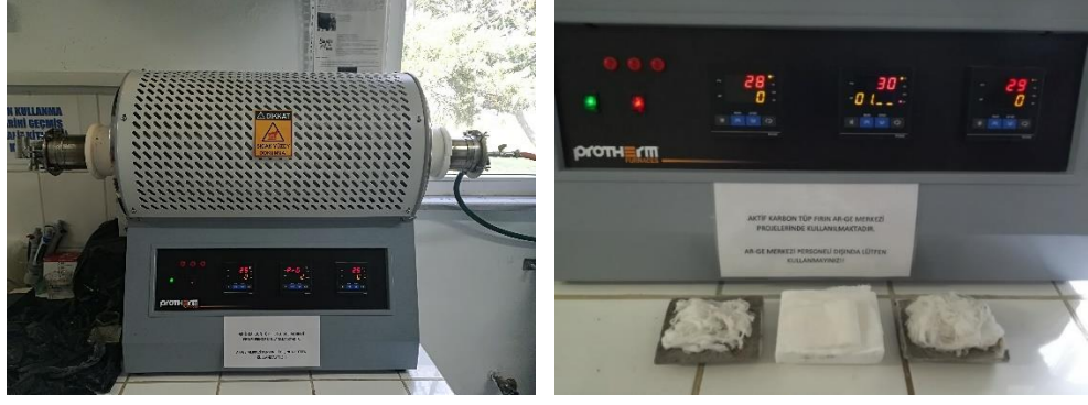
Şekil 2.13 Tüp fırını (Proterm Furnaces PZF Series)
