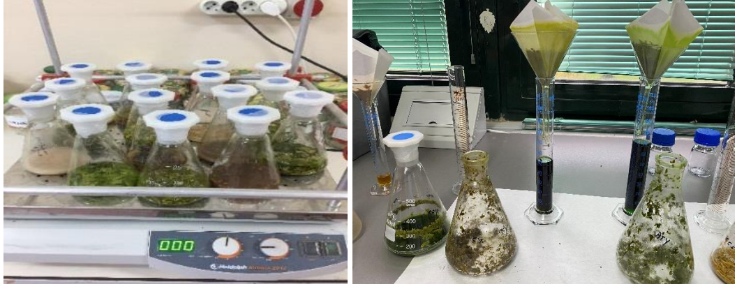
Şekil 6. Analizlerde kullanılacak bitki örneklerinin ekstraksiyonu
