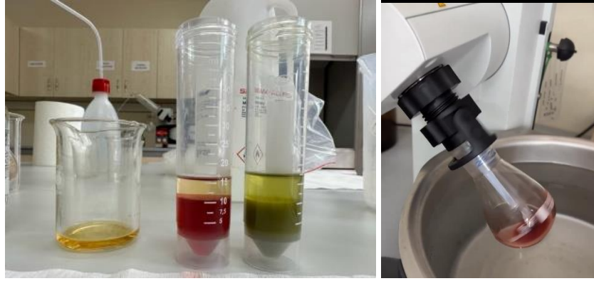
Şekil 14. Ekstraksiyon ve çözücü uçurma işlemi
