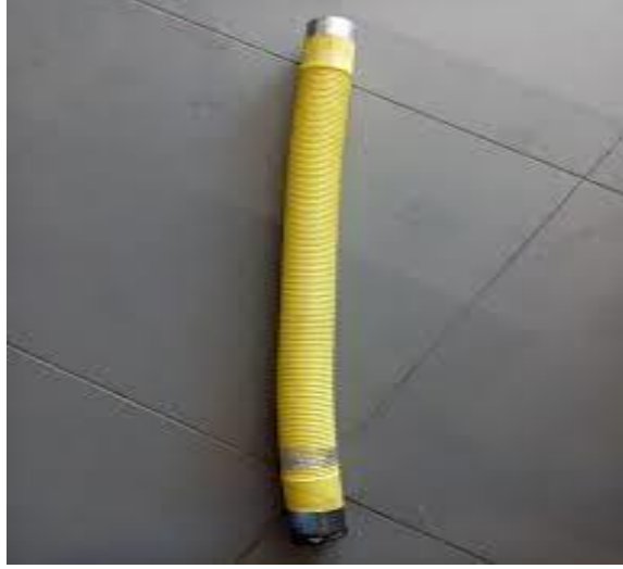
Şekil 4.17 Doğalgaz tesisatında bulunan bir kompansatör
