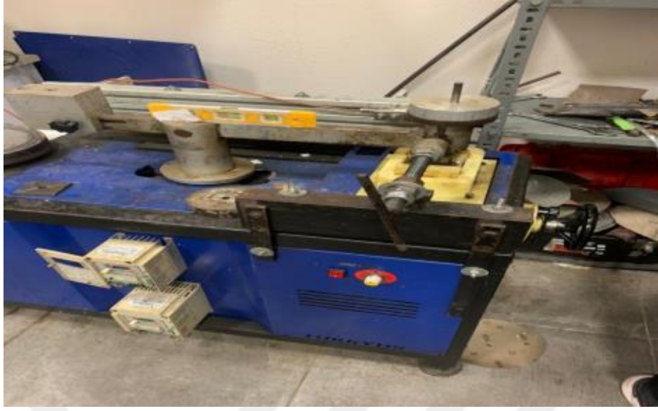
Şekil 6.7. İleri-geri aşınma test cihazının şematik gösterimi
