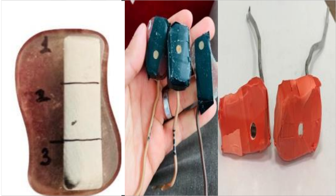
Şekil 6.11. Korozyon test numuneleri
