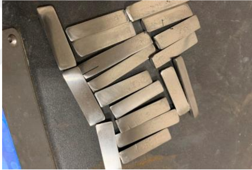
Şekil 6.5. Su jeti ile kesilmiş bi-metal numuneler
