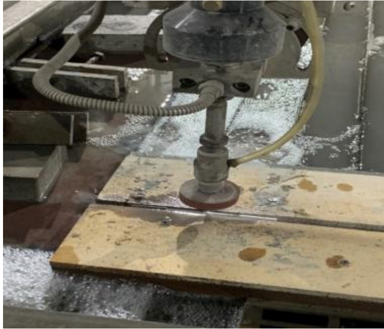
Şekil 6.3. Su jeti makinesi ile kesim işleminin yapılışı
