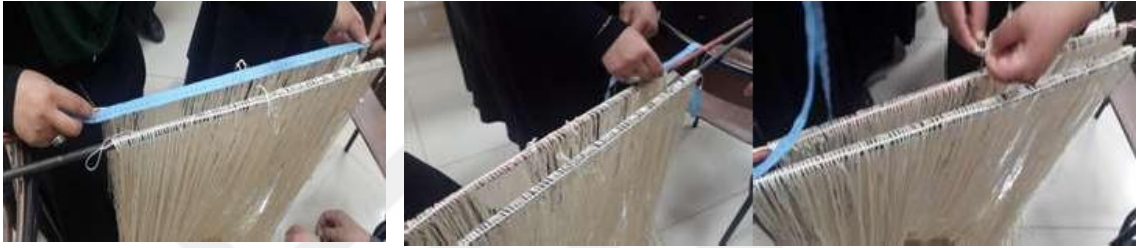
Fotoğraf 4.23. Halı Çözgüsünün Demir Çubuğa Alındıktan Sonra ölçülmesi
