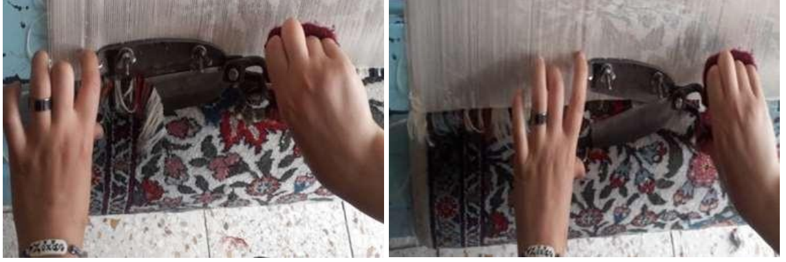
Fotoğraf 4.12. Halı Hav Kesim Makasının Kullanım Şekli
