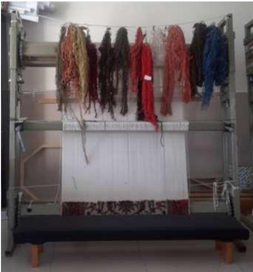
Fotoğraf 4. 2. İlde Kullanılan Metal Sarma halı Tezgâh ve Germe Ahşap Tezgâh Örneği
