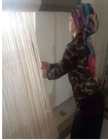
Fotoğraf 4.25. Dokuma Tezgâhına Aktarılan Çözügünün Çekilerek Düzeltilmesi
