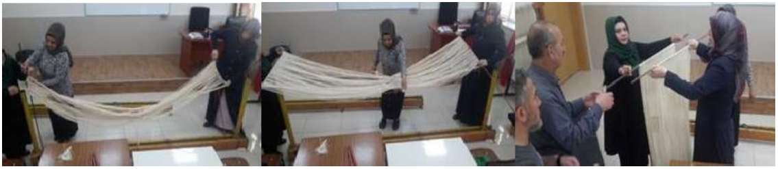
Fotoğraf 4.22. Halı Çözgüsünün Demir Çubuğa Alındıktan Sonra Düzeltilmesi Hizalanması
