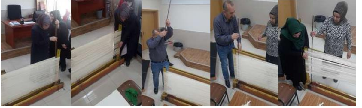
Fotoğraf 4.21. Halı Çözgüsünün Aparattan Demir Çubuğa Aktarılması
