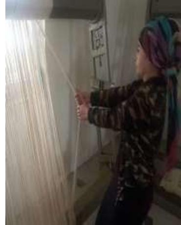
Fotoğraf 4.25. Dokuma Tezgâhına Aktarılan Çözügünün Çekilerek Düzeltilmesi
