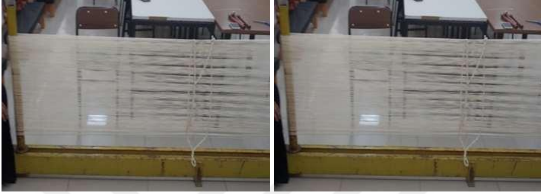
Fotoğraf 4. 7. Halı Çözüğü hazırlamada kullanılan Çözüğü Demiri
