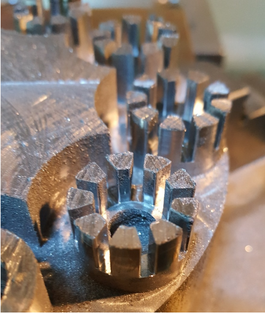
Şekil 2.10: YMK malzeme ile manyetik nüve üretimi.
