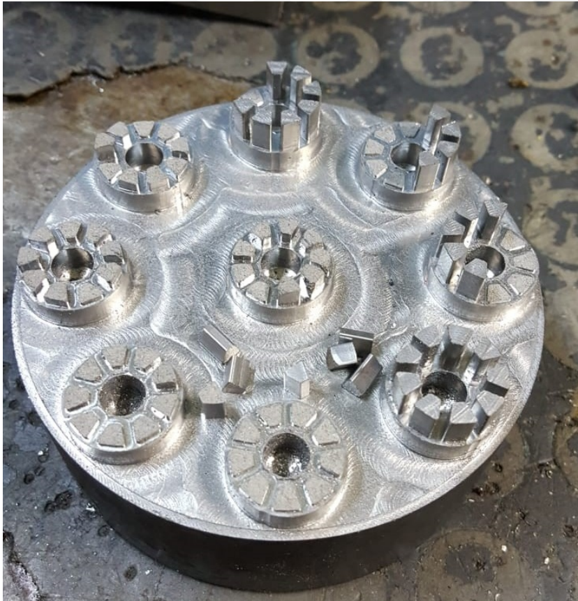
Şekil 6.5: EAKMSM YMK stator üretiminde hatalı işlenen nüveler.
