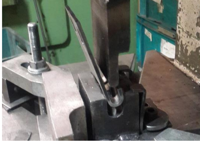
Şekil 1.8: Kavisli kalıp ile bükülen bir sac malzeme
