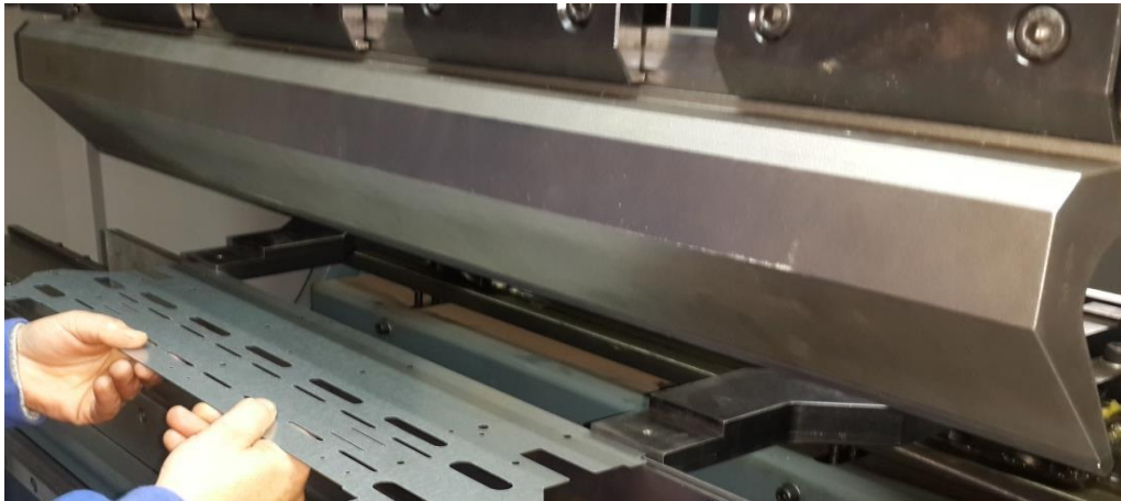
Şekil 1.11: Kazboynu stampalı üst kalıp görseli (Bozkurt,2018)
