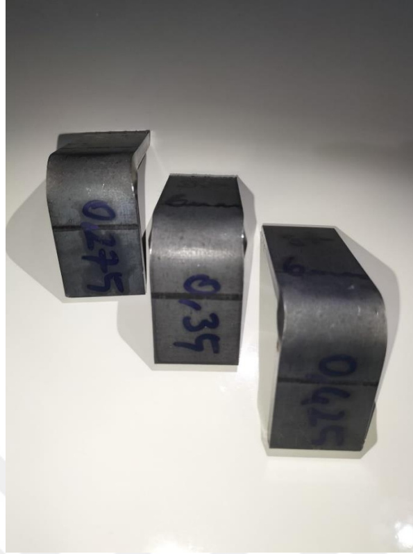
Şekil 4.12: 6 mm St37 sacının 0,275-0,350-0,425 k-faktörlerine göre bükümleri
