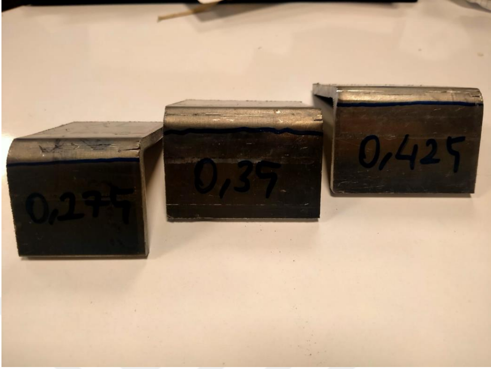
Şekil 4.8: 6 mm Alüminyum5754 – H111 sacının 0,275-0,350-0,425 k-faktörlerine göre bükümleri
