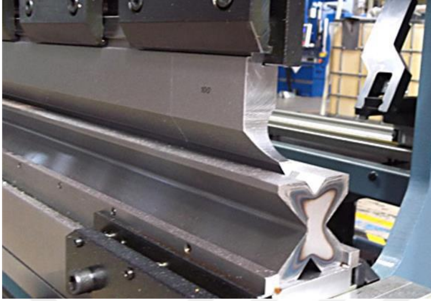
Şekil 1.2: Dört farklı V kalıbı barındıran bir X kalıbı
