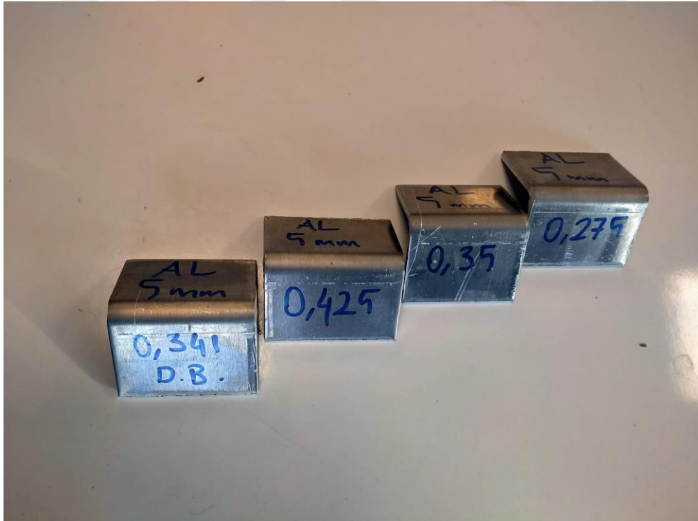
Şekil 4.7: 5 mm Alüminyum5754 – H111 sacının doğrulama bükümü olan 0,341 ve 0,275-0,350-0,425 k-faktörlerine göre bükümleri
