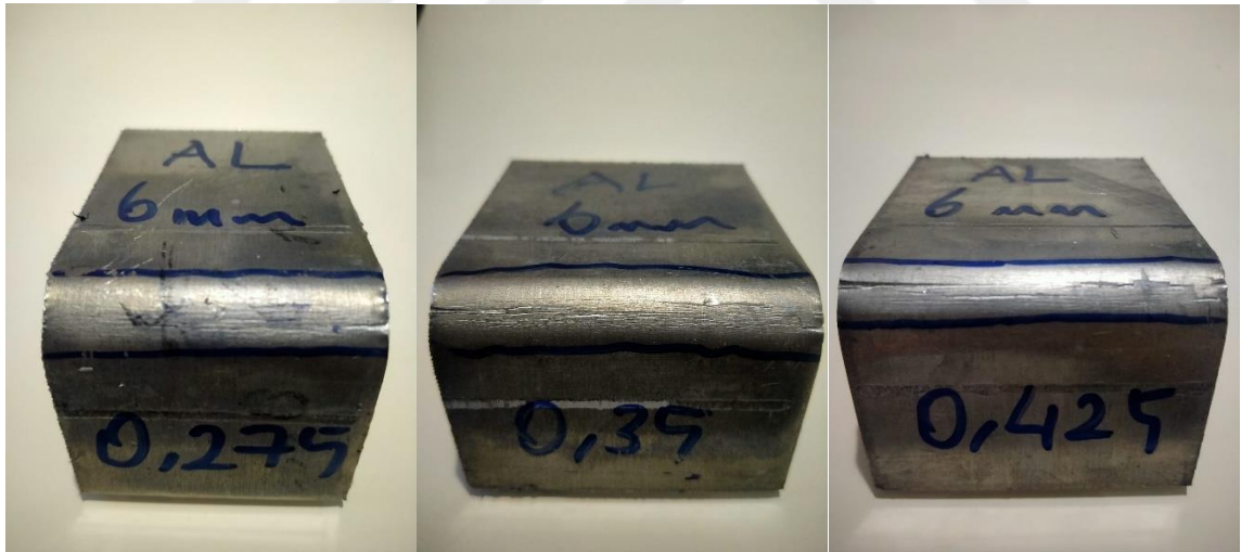
Şekil 4.9: 6 mm Alüminyum5754 – H111 sacının 0,275-0,35-0,425 k-faktörlerine göre bükümleri sonrası ortaya çıkan çatlakların görünüşü
