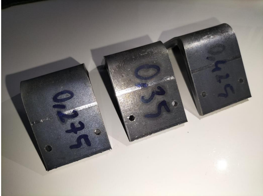
Şekil 4.11: 5 mm St37 sacının 0,275-0,350-0,425 k-faktörlerine göre bükümleri
