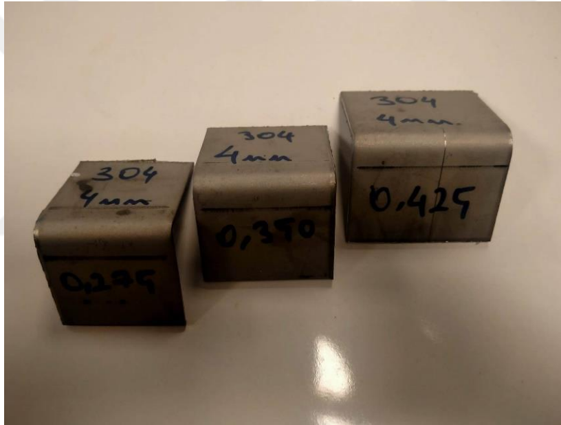
Şekil 4.5: 4 mm AISI 304 kalite paslanmaz çeliğinin 0,275-0,350 ve 0,425 k-faktörlerine göre bükümleri
