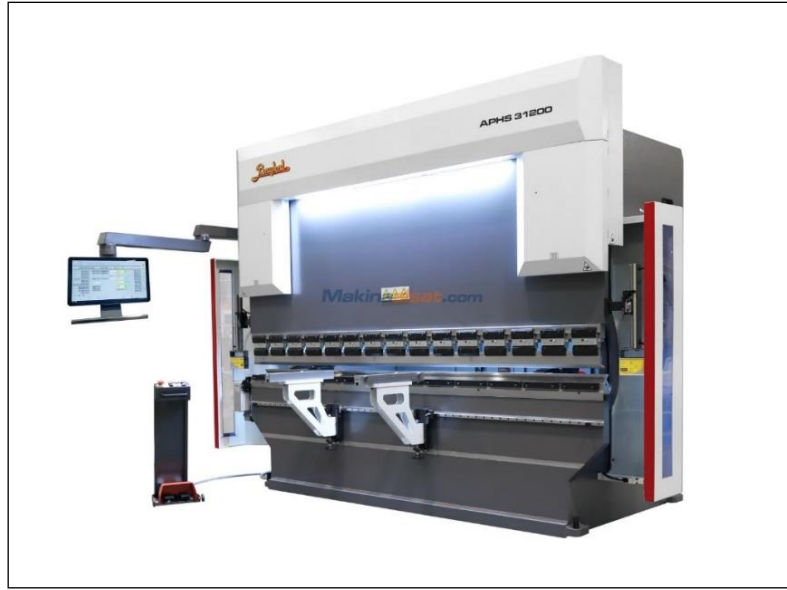
Şekil 3.1: Bükümlerin gerçekleştirildiği hidrolik abkant pres
