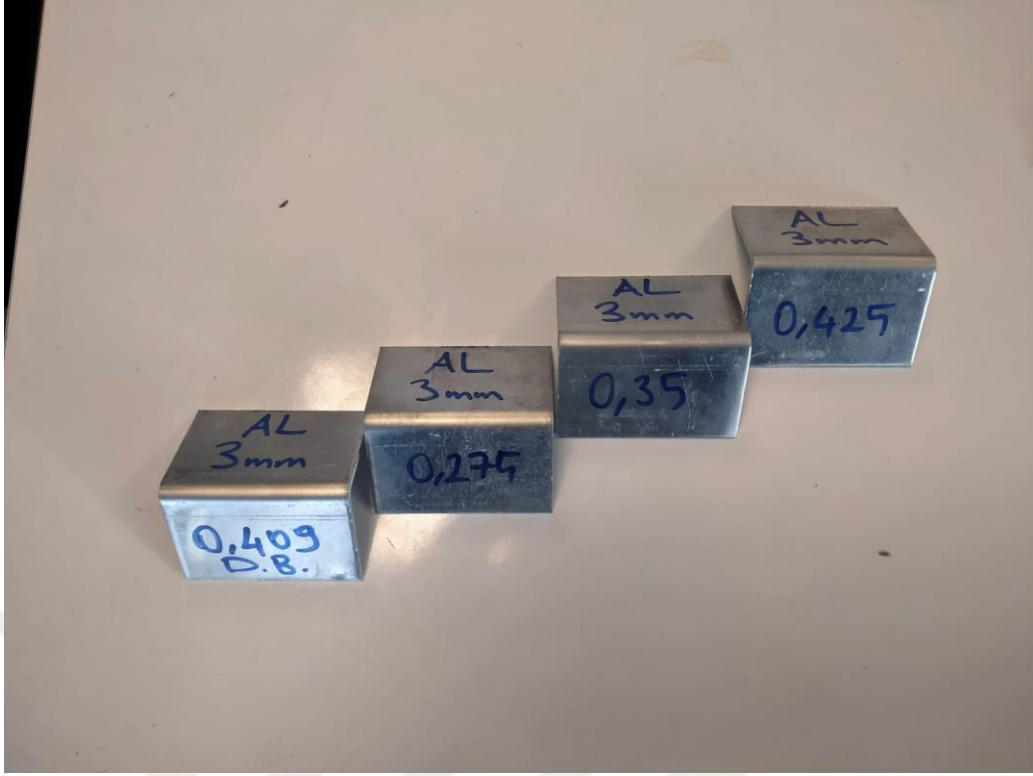
Şekil 4.6: 3 mm Alüminyum5754 – H111 sacının doğrulama bükümü olan 0,409 ve 0,275-0,350-0,425 k-faktörlerine göre bükümleri
