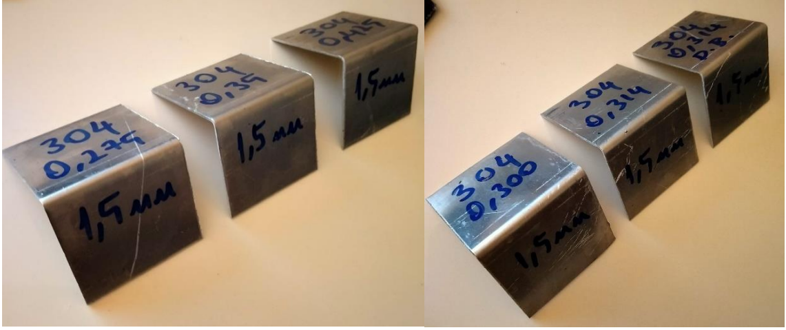
Şekil 4.4: 1,5 mm AISI 304 kalite paslanmaz çeliğinin verilen k-faktörlerine göre bükümleri
