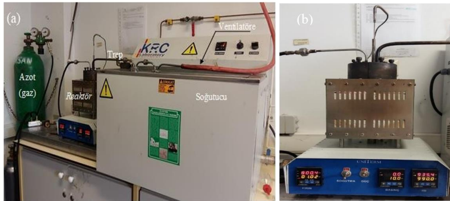
Şekil 9.20. (a) Deney düzeneği, (b) UNITERM yüksek sıcaklık reaktörü görüntüsü
