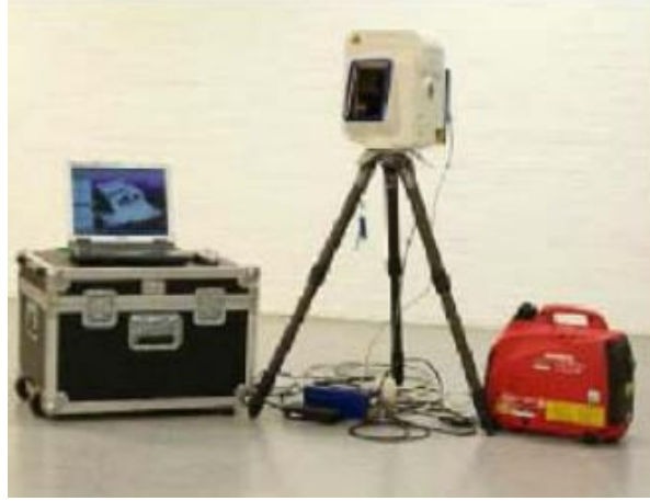
Şekil 3.1 Bir lazer tarayıcı bileşenleri (Barber vd., 2002)
