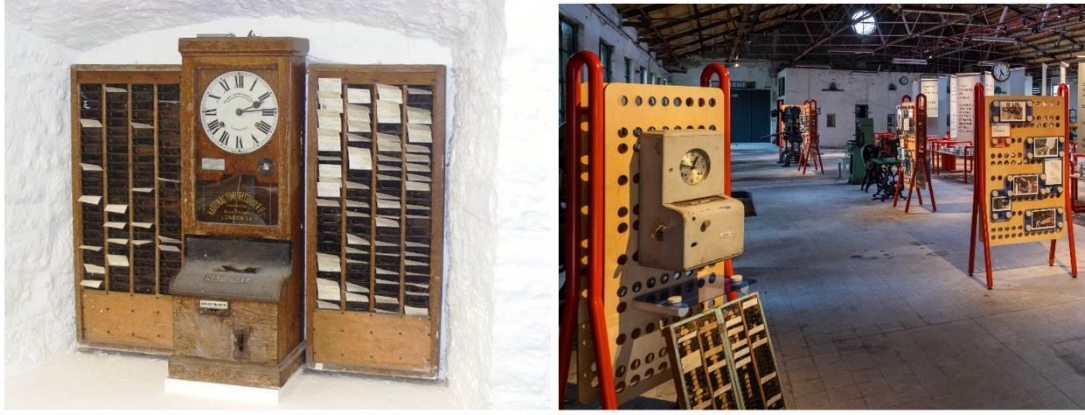
Görsel 3.2: Solda kart basma saati, raflı kart dolabı ve dolabın içinde işçi puantaj kartları 36 . Sağda ise teknoloji bakımından dönemsel olarak Bomonti Bira Fabrikası ile benzer niteliklerine sahip Beykoz Kundura Fabrikası'nda sergilenen kart basma saati 37 .
