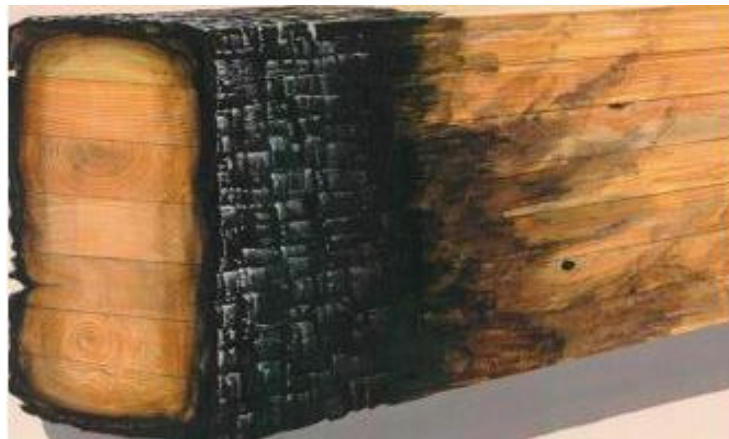
Şekil 2.3. Yangından Çıkarılmış Ahşap Yüzeyinde Sertleşme (Kömürleşme)
