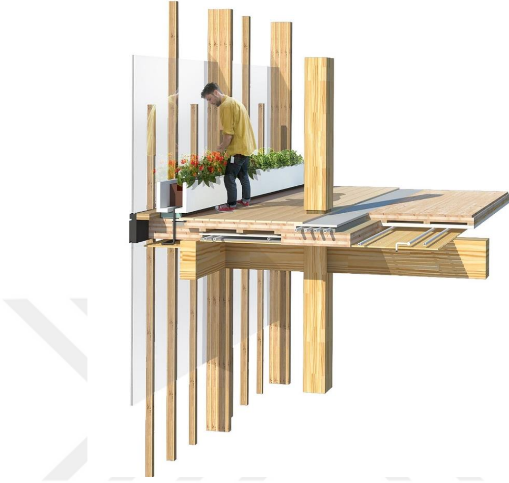
Şekil 3.21. Döşemede Tesisat Gösterimi
