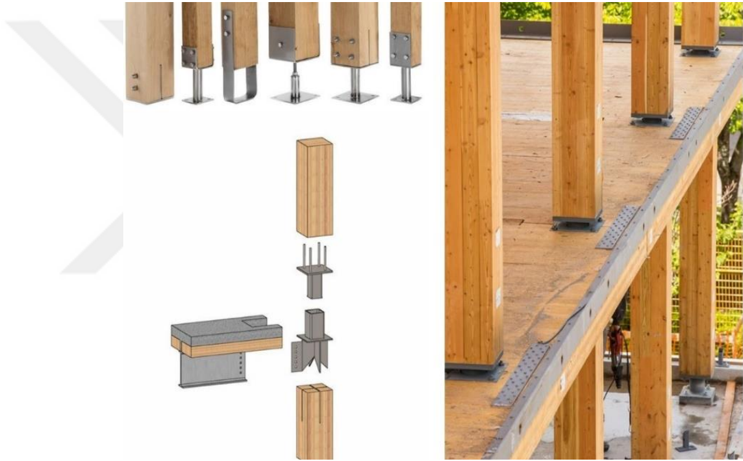
Şekil 3.20. Kolon Montaj İşlemi Detayı
