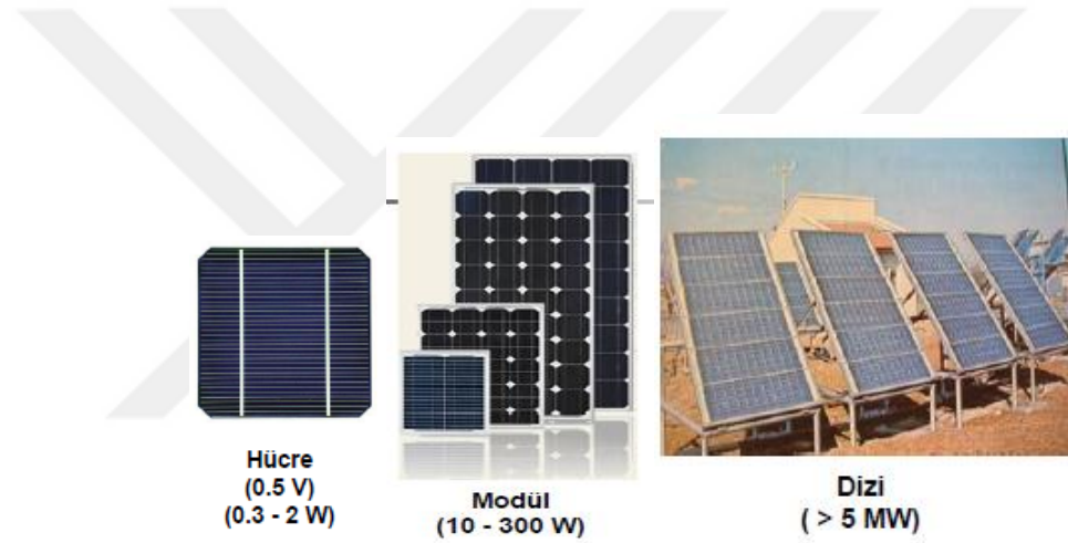
Şekil 3.4 PV sistemlerinde hücre-modül-dizi tasarımı (Öztürk, 2019)
