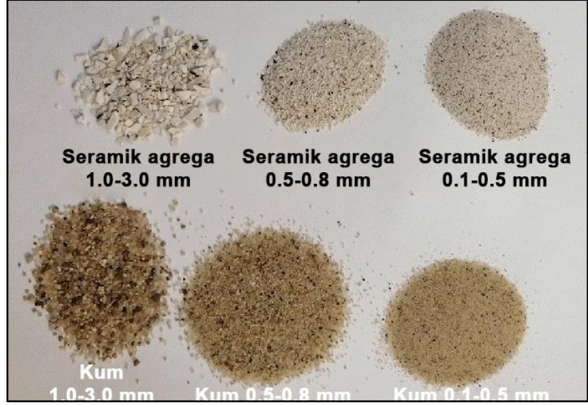
Şekil 3.1 Aynı gradasyon aralığındaki ince agreganın (alt) seramik ince agregaya (üst) göre farkı (Klimek et al.,2020)
