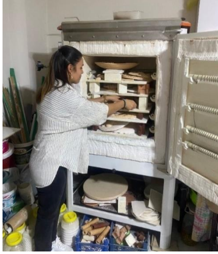
Görsel 212-213: Bisküvi Pişirimi İçin Fırın İçerisine Yerleştirilen Seramikler Kaynak: (Semra Özdemir'in Kişisel Arşivi)
