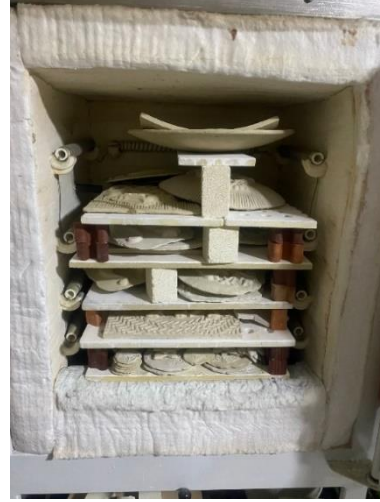
Görsel 212-213: Bisküvi Pişirimi İçin Fırın İçerisine Yerleştirilen Seramikler Kaynak: (Semra Özdemir'in Kişisel Arşivi)
