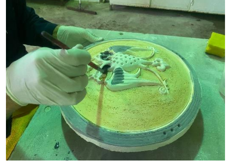
Görsel 217-218-219: Fırça Yardımı ile Sırlama İşlemi Kaynak: (Semra Özdemir'in Kişisel Arşivi)
