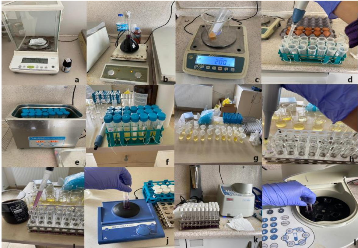
Şekil 3.17. DPPH radikal giderim aktivitesi analizi (a-b-c: DPPH çözeltisinin hazırlanması, d: Yumurta numuneleri üzerine metanol ilavesi, e: Numunelerin ultrasonik banyoda ekstraksiyonu, f: Ekstrakte olmuş numuneler, g: Süzme, h: Cam tüplere süzntülerin eklenmesi, i: DPPH çözelti ilavesi, j: Tüplerin vortex ile homojenize edilmesi, k: Numunelerin spektrofotometre ile ölçümüne hazırlanması, l: Numunelerin spektrofotometre ile ölçülmesi
