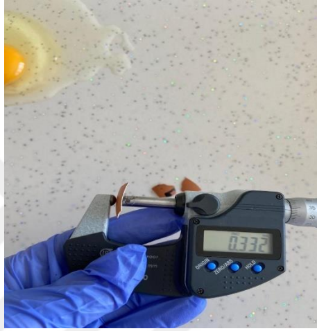
Şekil 3.13. Yumurta kabuk kalınlığının belirlenmesi
