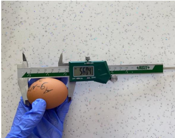
Şekil 3.8. Dijital kumpas ile yumurtanın eni ve boyunun ölçülmesi
