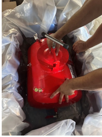
Şekil 4.8. Hızlandırılmış karbonatlaşma tankı hava sızdırmazlığı kontrolü
