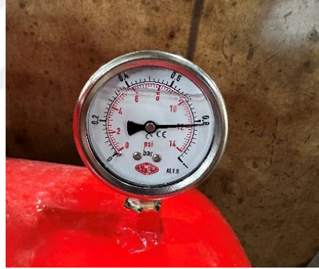
Şekil 4.12. Hızlandırılmış karbonatlaşma test kiti 0,8 bar manometre değeri
