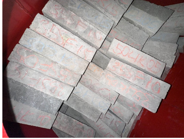
Şekil 4.11. Hızlandırılmış karbonatlaşma tankı içerisindeki harç numuneleri
