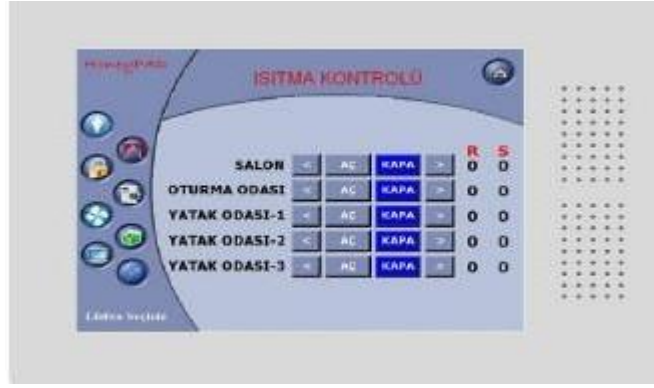
Şekil 2.3. Isıtma ve soğutma sistemleri ana kontrol ekranı dokunmatik paneli (Shahbazi Jamalabad, 2014)
