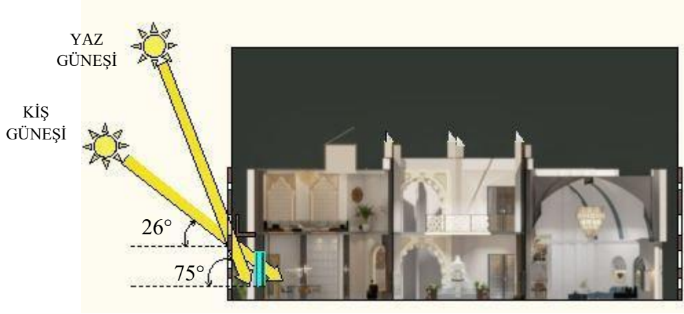
Şekil 5.21. Yaz ve kış aylarında güneş ışığının açısı arasındaki fark
