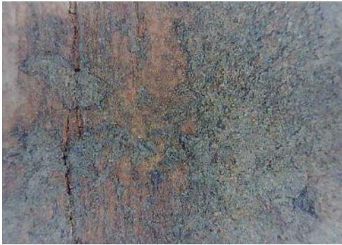
Resim 3.306. Taşkınpaşa Camii minberi yüzey birikintileri, toz ve kir / lekelenme detay fotoğrafı 14 (a) Fotoğraf makinesi çekimi (b) Optik Mikroskopta x50 büyüklükte detay görüntüsü (c) Optik Mikroskopta x200 büyüklükte detay görüntüsü.
