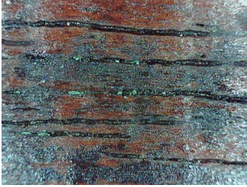
Resim 3.615. Gazanfer Ağa Camii vaaz kürsüsü tabakalaşma ve yüzeyden ayrılma detay fotoğrafı 13. (a) Fotoğraf makinesi çekimi b) Optik Mikroskopta x50 büyüklükte tabaka detay görüntüsü b) Optik Mikroskopta x200 büyüklükte tabaka detay görüntüsü.
