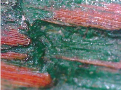
Resim 3.517. Şeyh Bahşi Mescidi vaaz kürsüsü geçmiş dönem uygulanan raspa işlemi sonrası yüzey kalıntıları. (a) Fotoğraf makinesi çekimi b) Optik Mikroskopta x50 büyüklükte tabaka detay görüntüsü c) Optik Mikroskopta x200 büyüklükte tabaka detay görüntüsü.
