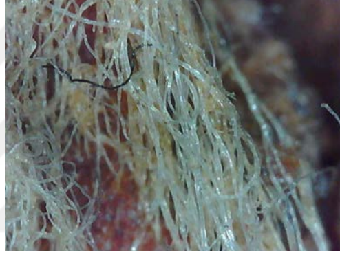
Resim 3.519. Şeyh Bahşi Mescidi vaaz kürsüsü birleşim elemanı yüzey birikinti örneği 2. (a) Fotoğraf makinesi çekimi b) Optik Mikroskopta x50 büyüklükte tabaka detay görüntüsü b) Optik Mikroskopta x200 büyüklükte tabaka detay görüntüsü.
