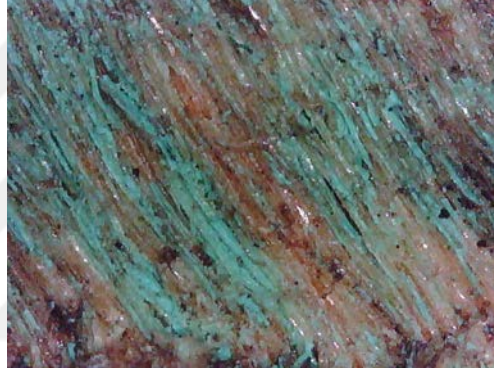
Resim 3.605. Gazanfer Ağa Camii vaaz kürsüsü tabakalaşma ve yüzeyden ayrılma detay fotoğrafı 3. (a) Fotoğraf makinesi çekimi b) Optik Mikroskopta x50 büyüklükte tabaka detay görüntüsü b) Optik Mikroskopta x200 büyüklükte tabaka detay görüntüsü.
