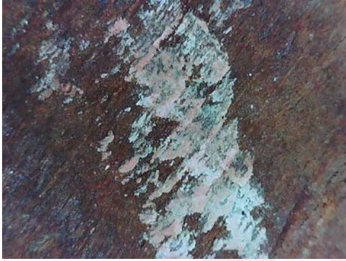
Resim 3.309. Taşkınpaşa Camii minberi yüzey birikintileri, toz ve kir / lekelenme detay fotoğrafı 17 (a) Fotoğraf makinesi çekimi (b) Optik Mikroskopta x50 büyüklükte detay görüntüsü (c) Optik Mikroskopta x200 büyüklükte detay görüntüsü.
