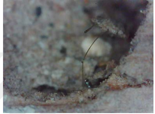
Resim 3.327. Taşkınpaşa Camii minberi böceklenme ve böcek uçuş delikleri detay fotoğrafı 9 (a) Fotoğraf makinesi çekimi (b) Optik Mikroskopta x50 büyüklükte detay görüntüsü (c) Optik Mikroskopta x200 büyüklükte detay görüntüsü.
