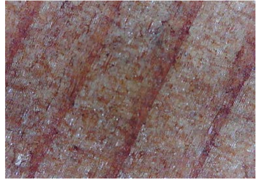
Resim 3.304. Taşkınpaşa Camii minberi yüzey birikintileri, toz ve kir / lekelenme detay fotoğrafı 12 (a) Fotoğraf makinesi çekimi (b) Optik Mikroskopta x50 büyüklükte detay görüntüsü (c) Optik Mikroskopta x200 büyüklükte detay görüntüsü.
