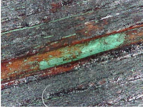
Resim 3.614. Gazanfer Ağa Camii vaaz kürsüsü tabakalaşma ve yüzeyden ayrılma detay fotoğrafı 12. (a) Fotoğraf makinesi çekimi b) Optik Mikroskopta x50 büyüklükte tabaka detay görüntüsü b) Optik Mikroskopta x200 büyüklükte tabaka detay görüntüsü.
