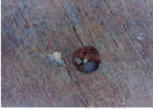
Resim 3.321. Taşkınpaşa Camii minberi böceklenme ve böcek uçuş delikleri detay fotoğrafı 3 (a) Fotoğraf makinesi çekimi (b) Optik Mikroskopta x50 büyüklükte detay görüntüsü (c) Optik Mikroskopta x200 büyüklükte detay görüntüsü.
