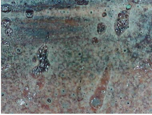
Resim 3.632. Gazanfer Ağa Camii vaaz kürsüsü ayak kısmı toz ve kir bozulması örneği. (a) Fotoğraf makinesi çekimi b) Optik Mikroskopta x50 büyüklükte tabaka detay görüntüsü b) Optik Mikroskopta x200 büyüklükte tabaka detay görüntüsü.
