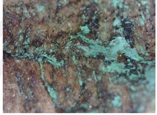
Resim 3.604. Gazanfer Ağa Camii vaaz kürsüsü tabakalaşma ve yüzeyden ayrılma detay fotoğrafı 2. (a) Fotoğraf makinesi çekimi b) Optik Mikroskopta x50 büyüklükte tabaka detay görüntüsü b) Optik Mikroskopta x200 büyüklükte tabaka detay görüntüsü.
