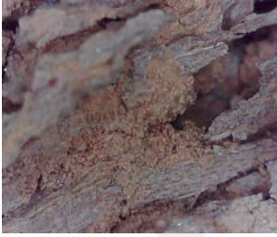
Resim 3.329. Taşkınpaşa Camii minberi böceklenme ve böcek uçuş delikleri detay fotoğrafı 11 (a) Fotoğraf makinesi çekimi (b) Optik Mikroskopta x50 büyüklükte detay görüntüsü (c, d) Optik Mikroskopta x200 büyüklükte detay görüntüsü.
