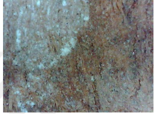
Resim 3.296. Taşkınpaşa Camii minberi yüzey birikintileri, toz ve kir / lekelenme detay fotoğrafı 4 (a) Fotoğraf makinesi çekimi (b) Optik Mikroskopta x50 büyüklükte detay görüntüsü (c) Optik Mikroskopta x200 büyüklükte detay görüntüsü.
