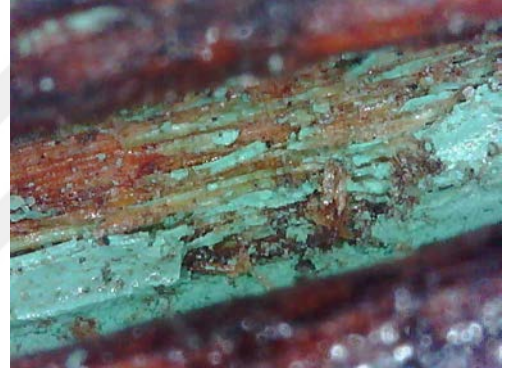
Resim 3.614. Gazanfer Ağa Camii vaaz kürsüsü tabakalaşma ve yüzeyden ayrılma detay fotoğrafı 12. (a) Fotoğraf makinesi çekimi b) Optik Mikroskopta x50 büyüklükte tabaka detay görüntüsü b) Optik Mikroskopta x200 büyüklükte tabaka detay görüntüsü.
