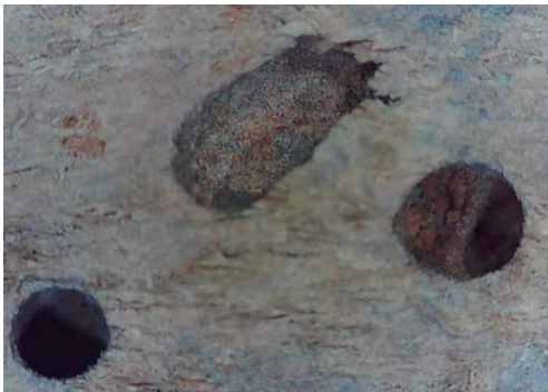
Resim 3.328. Taşkınpaşa Camii minberi böceklenme ve böcek uçuş delikleri detay fotoğrafı 10 (a) Fotoğraf makinesi çekimi (b) Optik Mikroskopta x50 büyüklükte detay görüntüsü (c) Optik Mikroskopta x200 büyüklükte detay görüntüsü.
