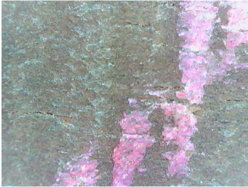
Resim 3.301. Taşkınpaşa Camii minberi yüzey birikintileri, toz ve kir / lekelenme detay fotoğrafı 9 (a) Fotoğraf makinesi çekimi (b) Optik Mikroskopta x50 büyüklükte detay görüntüsü (c) Optik Mikroskopta x200 büyüklükte detay görüntüsü.
