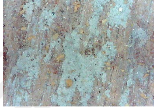
Resim 3.300. Taşkınpaşa Camii minberi yüzey birikintileri, toz ve kir / lekelenme detay fotoğrafı 8 (a) Fotoğraf makinesi çekimi (b) Optik Mikroskopta x50 büyüklükte detay görüntüsü (c) Optik Mikroskopta x200 büyüklükte detay görüntüsü.
