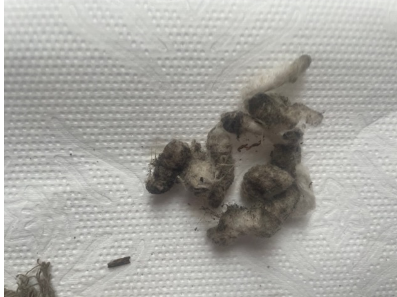
Resim 3.164. Taşkınpaşa Camii mihrabı yüzeyi ıslak temizlik sonrası yüzey kirlilik örnekleri.
