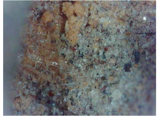
Resim 3.320. Taşkınpaşa Camii minberi böceklenme ve böcek uçuş delikleri detay fotoğrafı 2 (a) Fotoğraf makinesi çekimi (b) Optik Mikroskopta x50 büyüklükte detay görüntüsü (c) Optik Mikroskopta x200 büyüklükte detay görüntüsü.
