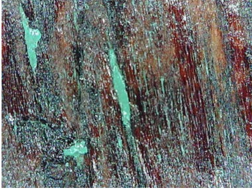
Resim 3.609. Gazanfer Ağa Camii vaaz kürsüsü tabakalaşma ve yüzeyden ayrılma detay fotoğrafı 7. (a) Fotoğraf makinesi çekimi b) Optik Mikroskopta x50 büyüklükte tabaka detay görüntüsü b) Optik Mikroskopta x200 büyüklükte tabaka detay görüntüsü.
