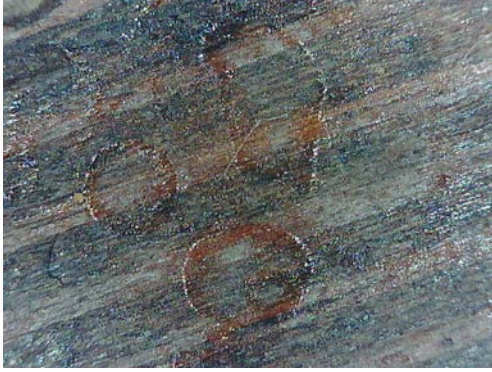
Resim 3.512. Şeyh Bahşı Mescidi vaaz kürsüsü yüzey lekelenmeleri 2. (a) Fotoğraf makinesi çekimi b) Optik Mikroskopta x50 büyüklükte tabaka detay görüntüsü b) Optik Mikroskopta x200 büyüklükte tabaka detay görüntüsü.
