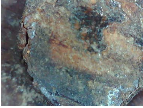
Resim 3.520. Şeyh Bahşi Mescidi vaaz kürsüsü birleşim elemanı yüzey birikinti örneği 3. (a) Fotoğraf makinesi çekimi b) Optik Mikroskopta x50 büyüklükte tabaka detay görüntüsü b) Optik Mikroskopta x200 büyüklükte tabaka detay görüntüsü.
