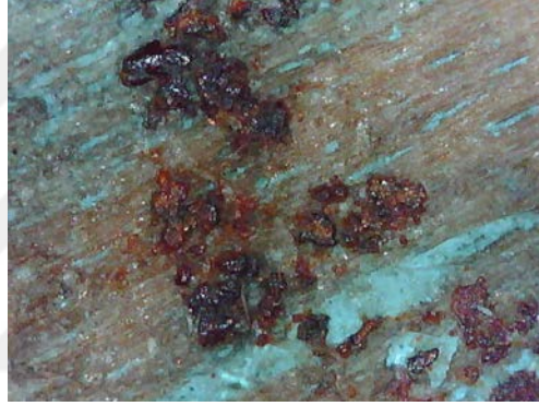
Resim 3.631. Gazanfer Ağa Camii vaaz kürsüsü rahle kısmı yüzeysel lekelenme örneği 2. (a) Fotoğraf makinesi çekimi b) Optik Mikroskopta x50 büyüklükte tabaka detay görüntüsü b) Optik Mikroskopta x200 büyüklükte tabaka detay görüntüsü.
