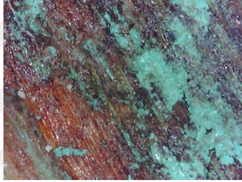
Resim 3.517. Şeyh Bahşi Mescidi vaaz kürsüsü geçmiş dönem uygulanan raspa işlemi sonrası yüzey kalıntıları. (a) Fotoğraf makinesi çekimi b) Optik Mikroskopta x50 büyüklükte tabaka detay görüntüsü c) Optik Mikroskopta x200 büyüklükte tabaka detay görüntüsü.
