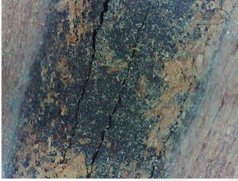
Resim 3.298. Taşkınpaşa Camii minberi yüzey birikintileri, toz ve kir / lekelenme detay fotoğrafı 6 (a) Fotoğraf makinesi çekimi (b) Optik Mikroskopta x50 büyüklükte detay görüntüsü (c) Optik Mikroskopta x200 büyüklükte detay görüntüsü.
