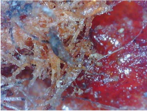
Resim 3.101. Taşkınpaşa Camii mihrabı yüzey birikintileri, toz ve kir / lekelenme detay fotoğrafı 6 (a) Fotoğraf makinesi çekimi (b, c) Optik Mikroskopta x50 büyüklükte detay görüntüsü (d, e) Optik Mikroskopta x200 büyüklükte detay görüntüsü.
