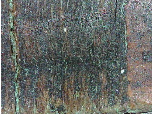
Resim 3.579. Gazanfer Ağa Camii vaaz kürsüsü budak kaynaklı oluşan bozulma örneği ve optik mikroskop detay görüntüsü 2. (a) Fotoğraf makinesi çekimi b) Optik Mikroskopta x50 büyüklükte tabaka detay görüntüsü b) Optik Mikroskopta x200 büyüklükte tabaka detay görüntüsü.
