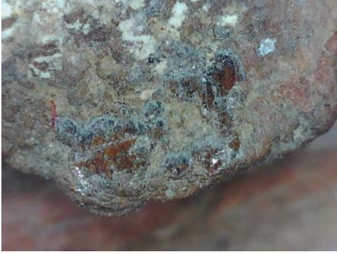
Resim 3.490. Şeyh Bahşi Mescidi vaaz kürsüsü tabakalaşma ve yüzeyden ayrılma detay fotoğrafı 2. (a) Fotoğraf makinesi çekimi b) Optik Mikroskopta x50 büyüklükte tabaka detay görüntüsü b) Optik Mikroskopta x200 büyüklükte tabaka detay görüntüsü.
