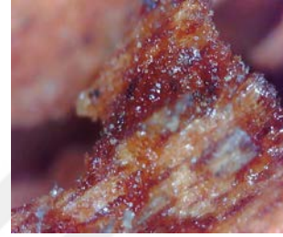
Resim 3.329. Taşkınpaşa Camii minberi böceklenme ve böcek uçuş delikleri detay fotoğrafı 11 (a) Fotoğraf makinesi çekimi (b) Optik Mikroskopta x50 büyüklükte detay görüntüsü (c, d) Optik Mikroskopta x200 büyüklükte detay görüntüsü.
