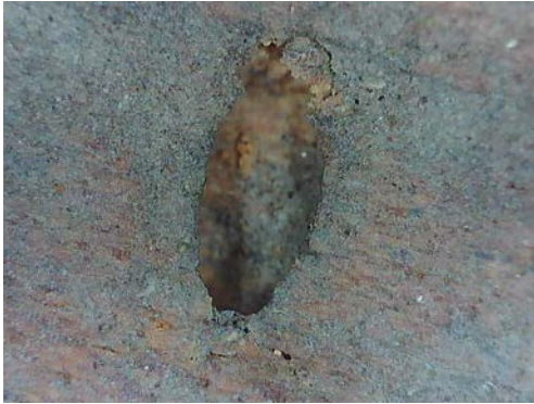
Resim 3.320. Taşkınpaşa Camii minberi böceklenme ve böcek uçuş delikleri detay fotoğrafı 2 (a) Fotoğraf makinesi çekimi (b) Optik Mikroskopta x50 büyüklükte detay görüntüsü (c) Optik Mikroskopta x200 büyüklükte detay görüntüsü.
