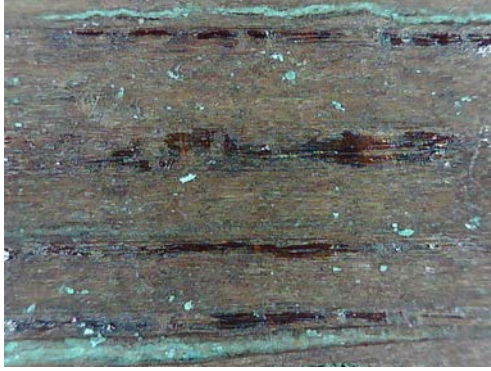
Resim 3.635. Gazanfer Ağa Camii vaaz kürsüsü rahle kısmı yüzeysel birikinti örneği ve detayları 2. (a) Fotoğraf makinesi çekimi (b, d) Optik Mikroskopta x50 büyüklükte tabaka detay görüntüsü (c, e) Optik Mikroskopta x200 büyüklükte tabaka detay görüntüsü.
