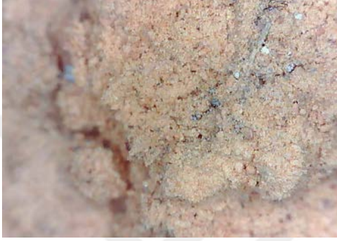
Resim 3.323. Taşkınpaşa Camii minberi böceklenme ve böcek uçuş delikleri detay fotoğrafı 5 (a) Fotoğraf makinesi çekimi (b) Optik Mikroskopta x50 büyüklükte detay görüntüsü (c) Optik Mikroskopta x200 büyüklükte detay görüntüsü.
