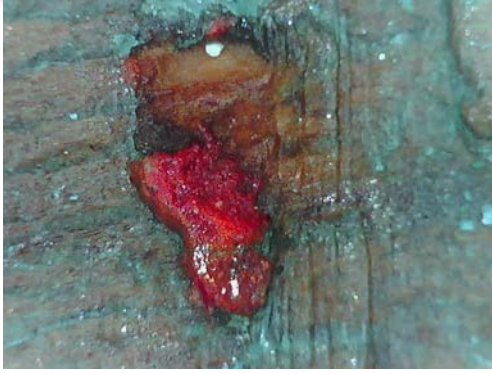
Resim 3.636. Gazanfer Ağa Camii vaaz kürsüsü rahle kısmı yüzeysel birikinti örneği ve detayları 3. (a) Fotoğraf makinesi çekimi b) Optik Mikroskopta x50 büyüklükte tabaka detay görüntüsü b) Optik Mikroskopta x200 büyüklükte tabaka detay görüntüsü.
