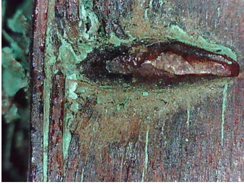
Resim 3.627. Gazanfer Ağa Camii vaaz kürsüsü taklit künde-kârî panel kısmında kullanılan metal çivilerde korozyon bozulma örneği ve detayı. (a) Fotoğraf makinesi çekimi b) Optik Mikroskopta x50 büyüklükte tabaka detay görüntüsü b) Optik Mikroskopta x200 büyüklükte tabaka detay görüntüsü.
