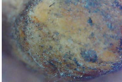
Resim 3.299. Taşkınpaşa Camii minberi yüzey birikintileri, toz ve kir / lekelenme detay fotoğrafı 7 (a) Fotoğraf makinesi çekimi (b) Optik Mikroskopta x50 büyüklükte detay görüntüsü (c) Optik Mikroskopta x200 büyüklükte detay görüntüsü.
