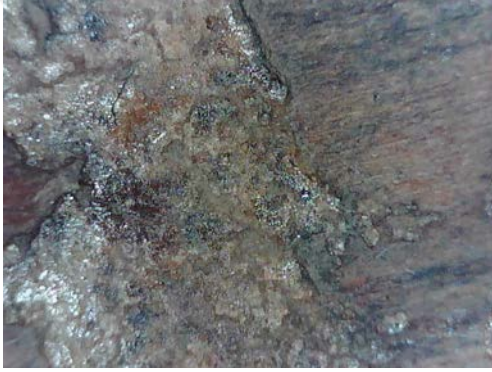
Resim 3.504. Şeyh Bahşı Mescidi vaaz kürsüsü renk değişimi örneği 3. (a) Fotoğraf makinesi çekimi b) Optik Mikroskopta x50 büyüklükte tabaka detay görüntüsü b) Optik Mikroskopta x200 büyüklükte tabaka detay görüntüsü.
