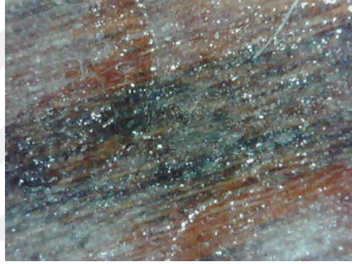
Resim 3.512. Şeyh Bahşı Mescidi vaaz kürsüsü yüzey lekelenmeleri 2. (a) Fotoğraf makinesi çekimi b) Optik Mikroskopta x50 büyüklükte tabaka detay görüntüsü b) Optik Mikroskopta x200 büyüklükte tabaka detay görüntüsü.
