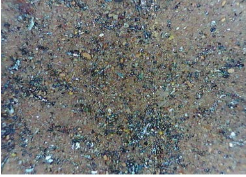
Resim 3.293. Taşkınpaşa Camii minberi yüzey birikintileri, toz ve kir / lekelenme detay fotoğrafı 1 (a) Fotoğraf makinesi çekimi (b) Optik Mikroskopta x50 büyüklükte detay görüntüsü (c) Optik Mikroskopta x200 büyüklükte detay görüntüsü.
