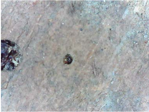
Resim 3.322. Taşkınpaşa Camii minberi böceklenme ve böcek uçuş delikleri detay fotoğrafı 4 (a) Fotoğraf makinesi çekimi (b) Optik Mikroskopta x50 büyüklükte detay görüntüsü (c) Optik Mikroskopta x200 büyüklükte detay görüntüsü.
