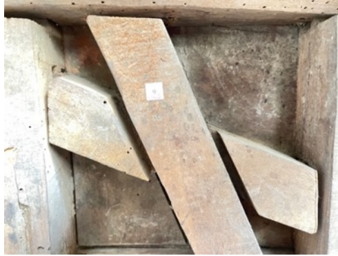
Resim 3.296. Taşkınpaşa Camii minberi yüzey birikintileri, toz ve kir / lekelenme detay fotoğrafı 4 (a) Fotoğraf makinesi çekimi (b) Optik Mikroskopta x50 büyüklükte detay görüntüsü (c) Optik Mikroskopta x200 büyüklükte detay görüntüsü.
