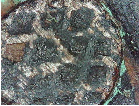
Resim 3.620. Gazanfer Ağa Camii vaaz kürsüsü korozyon bozulma örneği ve detayı 2. (a) Fotoğraf makinesi çekimi b) Optik Mikroskopta x50 büyüklükte tabaka detay görüntüsü b) Optik Mikroskopta x200 büyüklükte tabaka detay görüntüsü.
