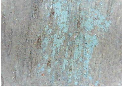
Resim 3.300. Taşkınpaşa Camii minberi yüzey birikintileri, toz ve kir / lekelenme detay fotoğrafı 8 (a) Fotoğraf makinesi çekimi (b) Optik Mikroskopta x50 büyüklükte detay görüntüsü (c) Optik Mikroskopta x200 büyüklükte detay görüntüsü.
