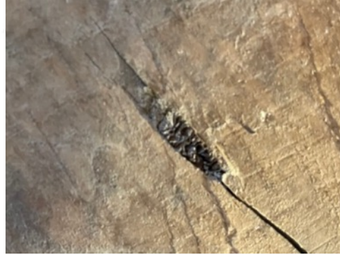
Resim 3.309. Taşkınpaşa Camii minberi yüzey birikintileri, toz ve kir / lekelenme detay fotoğrafı 17 (a) Fotoğraf makinesi çekimi (b) Optik Mikroskopta x50 büyüklükte detay görüntüsü (c) Optik Mikroskopta x200 büyüklükte detay görüntüsü.
