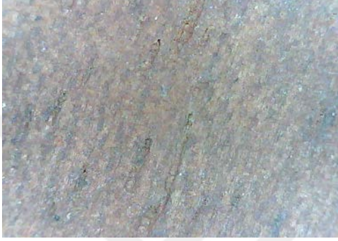
Resim 3.303. Taşkınpaşa Camii minberi yüzey birikintileri, toz ve kir / lekelenme detay fotoğrafı 11 (a) Fotoğraf makinesi çekimi (b) Optik Mikroskopta x50 büyüklükte detay görüntüsü (c) Optik Mikroskopta x200 büyüklükte detay görüntüsü.
