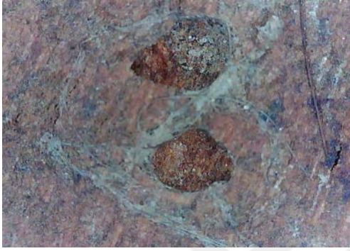
Resim 3.325. Taşkınpaşa Camii minberi böceklenme ve böcek uçuş delikleri detay fotoğrafı 7 (a) Fotoğraf makinesi çekimi (b) Optik Mikroskopta x50 büyüklükte detay görüntüsü (c) Optik Mikroskopta x200 büyüklükte detay görüntüsü.
