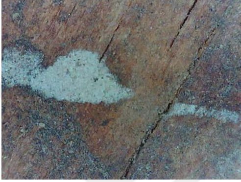
Resim 3.307. Taşkınpaşa Camii minberi yüzey birikintileri, toz ve kir / lekelenme detay fotoğrafı 15 (a) Fotoğraf makinesi çekimi (b) Optik Mikroskopta x50 büyüklükte detay görüntüsü (c) Optik Mikroskopta x200 büyüklükte detay görüntüsü.
