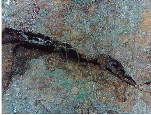
Resim 3.483.Şeyh Bahşi Mescidi vaaz kürsüsü çatlak ve ayrılma örneği 3. (a) Fotoğraf makinesi çekimi b) Optik Mikroskopta x50 büyüklükte tabaka detay görüntüsü b) Optik Mikroskopta x200 büyüklükte tabaka detay görüntüsü.
