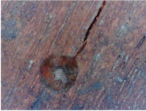
Resim 3.324. Taşkınpaşa Camii minberi böceklenme ve böcek uçuş delikleri detay fotoğrafı 6 (a) Fotoğraf makinesi çekimi (b) Optik Mikroskopta x50 büyüklükte detay görüntüsü (c) Optik Mikroskopta x200 büyüklükte detay görüntüsü.
