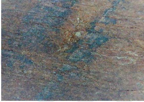
Resim 3.280. Taşkınpaşa Camii minberi renk değişim detay fotoğrafı 1 (a) Fotoğraf makinesi çekimi (b) Optik Mikroskopta x50 büyüklükte detay görüntüsü (c) Optik Mikroskopta x200 büyüklükte detay görüntüsü.
