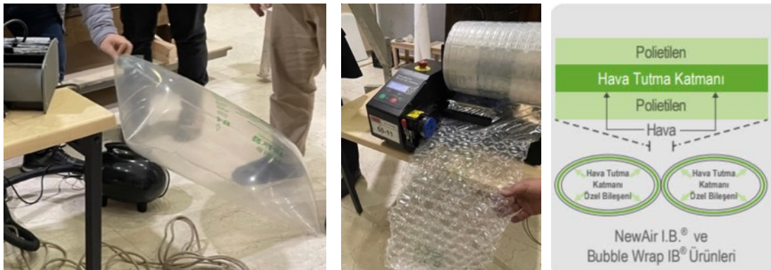
Resim 3.129. Paketleme işleminde kullanılan şişme yastıklama ve baloncuk sistemi görüntüleri.
