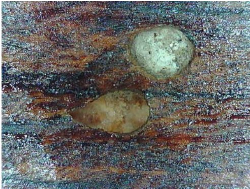
Resim 3.525. Şeyh Bahşi Mescidi vaaz kürsüsü yüzeyinde böcek uçuş delikleri detayı 1. (a) Fotoğraf makinesi çekimi b) Optik Mikroskopta x50 büyüklükte tabaka detay görüntüsü b) Optik Mikroskopta x200 büyüklükte tabaka detay görüntüsü.
