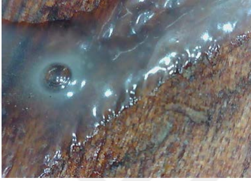
Resim 3.340. Taşkınpaşa Camii minberi niteliksiz onarım detay fotoğrafı 2 (a) Fotoğraf makinesi çekimi (b) Optik Mikroskopta x50 büyüklükte detay görüntüsü (c) Optik Mikroskopta x200 büyüklükte detay görüntüsü.
