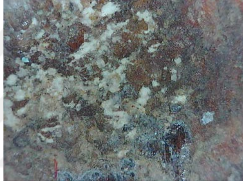
Resim 3.490. Şeyh Bahşi Mescidi vaaz kürsüsü tabakalaşma ve yüzeyden ayrılma detay fotoğrafı 2. (a) Fotoğraf makinesi çekimi b) Optik Mikroskopta x50 büyüklükte tabaka detay görüntüsü b) Optik Mikroskopta x200 büyüklükte tabaka detay görüntüsü.
