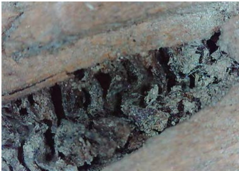
Resim 3.310. Taşkınpaşa Camii minberi yüzey birikintileri, toz ve kir / lekelenme detay fotoğrafı 18 (a) Fotoğraf makinesi çekimi (b) Optik Mikroskopta x50 büyüklükte detay görüntüsü (c) Optik Mikroskopta x200 büyüklükte detay görüntüsü.
