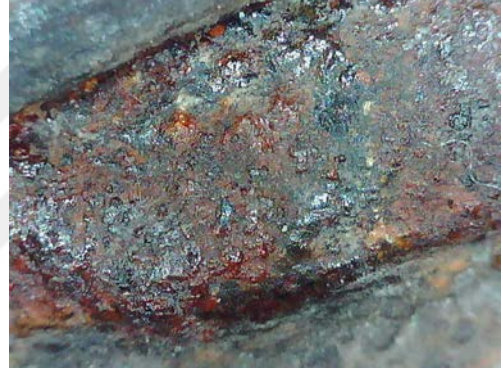
Resim 3.501. Şeyh Bahşi Mescidi vaaz kürsüsü korozyon görüntüsü 3. (a) Fotoğraf makinesi çekimi b) Optik Mikroskopta x50 büyüklükte tabaka detay görüntüsü b) Optik Mikroskopta x200 büyüklükte tabaka detay görüntüsü.
