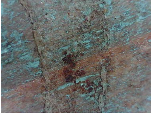
Resim 3.631. Gazanfer Ağa Camii vaaz kürsüsü rahle kısmı yüzeysel lekelenme örneği 2. (a) Fotoğraf makinesi çekimi b) Optik Mikroskopta x50 büyüklükte tabaka detay görüntüsü b) Optik Mikroskopta x200 büyüklükte tabaka detay görüntüsü.
