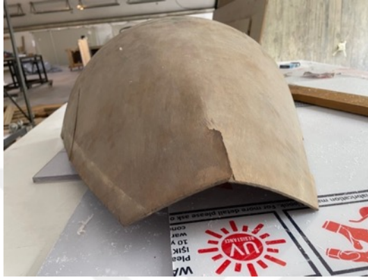
Resim 3.53. Taşkınpaşa Camii mihrabı kavsara kısmında meydana gelen kırılma örneğı detayları.
