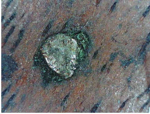
Resim 3.621. Gazanfer Ağa Camii vaaz kürsüsü taklit künde-kârî metal elemanlarında meydana gelen korozyon bozulma örneği ve detayı. (a) Fotoğraf makinesi çekimi (b, d) Optik Mikroskopta x50 büyüklükte tabaka detay görüntüsü (c, e) Optik Mikroskopta x200 büyüklükte tabaka detay görüntüsü.
