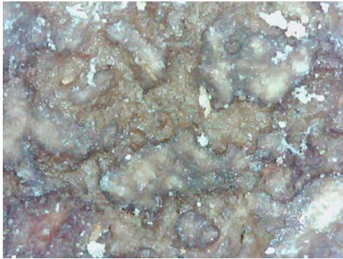
Resim 3.99. Taşkınpaşa Camii mihrabı yüzey birikintileri, toz ve kir / lekelenme detay fotoğrafı 4 (a) Fotoğraf makinesi çekimi (b, d, f) Optik Mikroskopta x50 büyüklükte detay görüntüsü (c, e, g) Optik Mikroskopta x200 büyüklükte detay görüntüsü.
