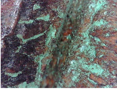
Resim 3.618. Gazanfer Ağa Camii vaaz kürsüsü tabakalaşma ve yüzeyden ayrılma detay fotoğrafı 16. (a) Fotoğraf makinesi çekimi b) Optik Mikroskopta x50 büyüklükte tabaka detay görüntüsü b) Optik Mikroskopta x200 büyüklükte tabaka detay görüntüsü.
