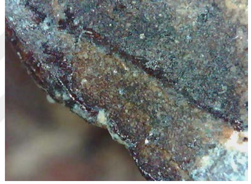
Resim 3.520. Şeyh Bahşi Mescidi vaaz kürsüsü birleşim elemanı yüzey birikinti örneği 3. (a) Fotoğraf makinesi çekimi b) Optik Mikroskopta x50 büyüklükte tabaka detay görüntüsü b) Optik Mikroskopta x200 büyüklükte tabaka detay görüntüsü.
