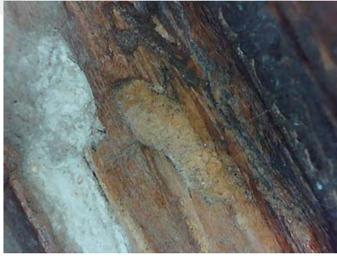
Resim 3.533. Şeyh Bahşi Mescidi vaaz kürsüsü farklı dolgu malzeme ile yapılan destek görüntü detayı 2. (a) Fotoğraf makinesi çekimi b) Optik Mikroskopta x50 büyüklükte tabaka detay görüntüsü b) Optik Mikroskopta x200 büyüklükte tabaka detay görüntüsü.
