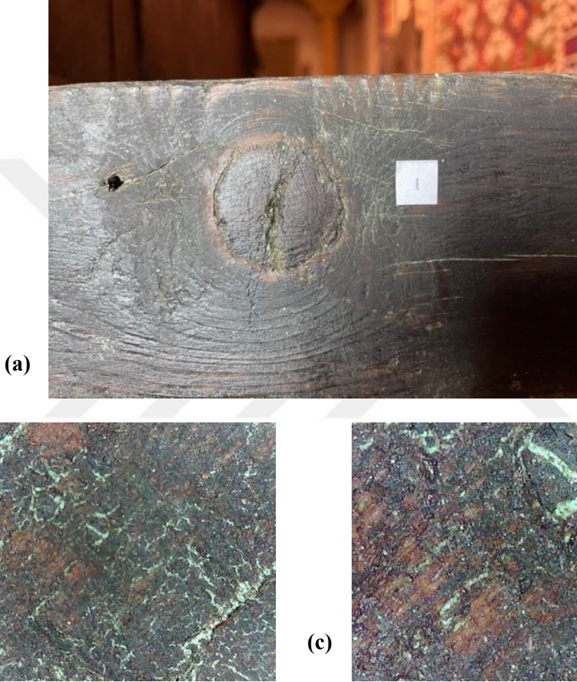
Resim 3.603. Gazanfer Ağa Camii vaaz kürsüsü tabakalaşma ve yüzeyden ayrılma detay fotoğrafı 1. (a) Fotoğraf makinesi çekimi b) Optik Mikroskopta x50 büyüklükte tabaka detay görüntüsü b) Optik Mikroskopta x200 büyüklükte tabaka detay görüntüsü.
