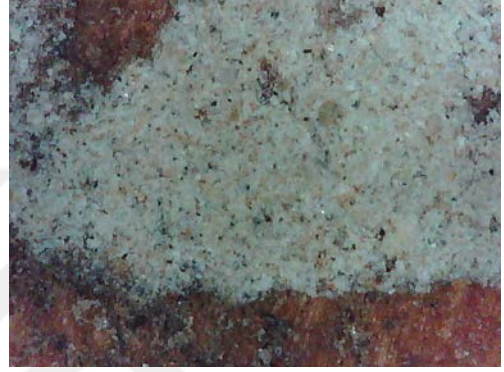
Resim 3.307. Taşkınpaşa Camii minberi yüzey birikintileri, toz ve kir / lekelenme detay fotoğrafı 15 (a) Fotoğraf makinesi çekimi (b) Optik Mikroskopta x50 büyüklükte detay görüntüsü (c) Optik Mikroskopta x200 büyüklükte detay görüntüsü.
