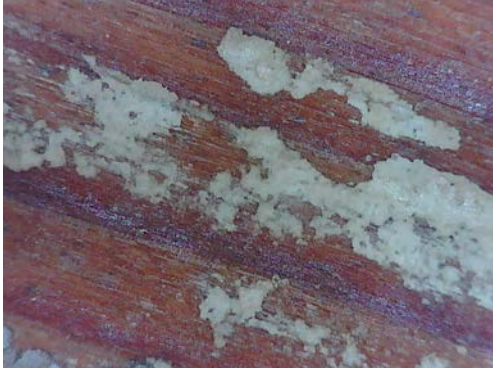
Resim 3.515. Şeyh Bahşi Mescidi vaaz kürsüsü geçmiş dönem uygulanan yüzey işlemi sonrası kalan birikintileri 2. (a) Fotoğraf makinesi çekimi b) Optik Mikroskopta x50 büyüklükte tabaka detay görüntüsü b) Optik Mikroskopta x200 büyüklükte tabaka detay görüntüsü.
