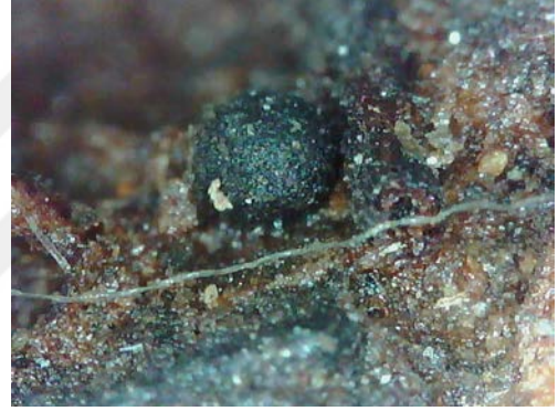
Resim 3.518. Şeyh Bahşi Mescidi vaaz kürsüsü birleşim elemanları yüzey birikinti örneği 1. (a) Fotoğraf makinesi çekimi b) Optik Mikroskopta x50 büyüklükte tabaka detay görüntüsü b) Optik Mikroskopta x200 büyüklükte tabaka detay görüntüsü.
