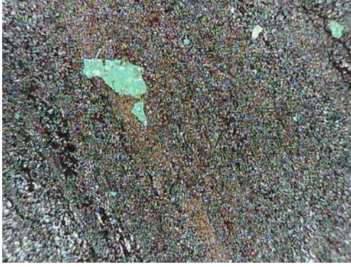
Resim 3.607. Gazanfer Ağa Camii vaaz kürsüsü tabakalaşma ve yüzeyden ayrılma detay fotoğrafı 5. (a) Fotoğraf makinesi çekimi b) Optik Mikroskopta x50 büyüklükte tabaka detay görüntüsü b) Optik Mikroskopta x200 büyüklükte tabaka detay görüntüsü.
