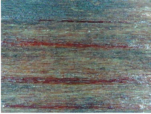
Resim 3.637. Gazanfer Ağa Camii vaaz kürsüsü arka korkuluk kısmı yüzeysel birikinti bozulması örneği ve detayları 1. (a) Fotoğraf makinesi çekimi b) Optik Mikroskopta x50 büyüklükte tabaka detay görüntüsü b) Optik Mikroskopta x200 büyüklükte tabaka detay görüntüsü.
