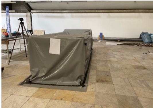
Resim 3.376. Taşkınpaşa Camii minberi ön yüzeyi azot çadırı işlem görüntüsü.
