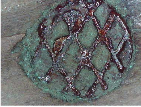
Resim 3.623. Gazanfer Ağa Camii vaaz kürsüsü rahle kısmı korozyon bozulma örneği ve detayı 2. (a) Fotoğraf makinesi çekimi b) Optik Mikroskopta x50 büyüklükte tabaka detay görüntüsü b) Optik Mikroskopta x200 büyüklükte tabaka detay görüntüsü.
