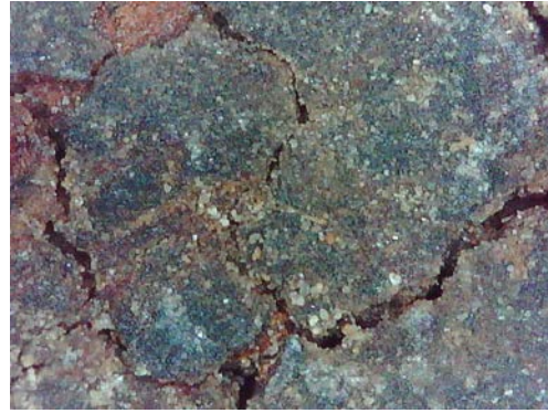
Resim 3.283. Taşkınpaşa Camii minberi renk değişim detay fotoğrafı 4 (a) Fotoğraf makinesi çekimi (b) Optik Mikroskopta x50 büyüklükte detay görüntüsü (c) Optik Mikroskopta x200 büyüklükte detay görüntüsü.
