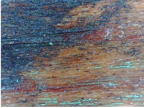
Resim 3.639. Gazanfer Ağa Camii vaaz kürsüsü renk değişimi detayı 1. (a) Fotoğraf makinesi çekimi b) Optik Mikroskopta x50 büyüklükte tabaka detay görüntüsü b) Optik Mikroskopta x200 büyüklükte tabaka detay görüntüsü.
