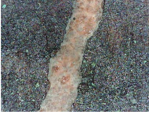
Resim 3.617. Gazanfer Ağa Camii vaaz kürsüsü tabakalaşma ve yüzeyden ayrılma detay fotoğrafı 15 (a) Fotoğraf makinesi çekimi b) Optik Mikroskopta x50 büyüklükte tabaka detay görüntüsü b) Optik Mikroskopta x200 büyüklükte tabaka detay görüntüsü.
