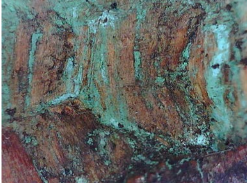
Resim 3.604. Gazanfer Ağa Camii vaaz kürsüsü tabakalaşma ve yüzeyden ayrılma detay fotoğrafı 2. (a) Fotoğraf makinesi çekimi b) Optik Mikroskopta x50 büyüklükte tabaka detay görüntüsü b) Optik Mikroskopta x200 büyüklükte tabaka detay görüntüsü.
