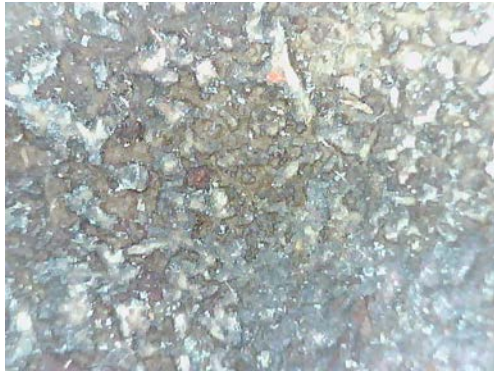
Resim 3.99. Taşkınpaşa Camii mihrabı yüzey birikintileri, toz ve kir / lekelenme detay fotoğrafı 4 (a) Fotoğraf makinesi çekimi (b, d, f) Optik Mikroskopta x50 büyüklükte detay görüntüsü (c, e, g) Optik Mikroskopta x200 büyüklükte detay görüntüsü.
