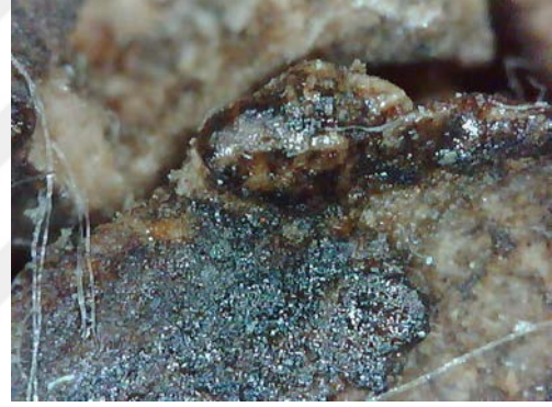
Resim 3.497. Şeyh Bahşi Mescidi vaaz kürsüsü tabakalaşma ve yüzeyden ayrılma detay fotoğrafı 9- (Yeşil boya tabakası) – 3. (a) Fotoğraf makinesi çekimi b) Optik Mikroskopta x50 büyüklükte tabaka detay görüntüsü b) Optik Mikroskopta x200 büyüklükte tabaka detay görüntüsü.
