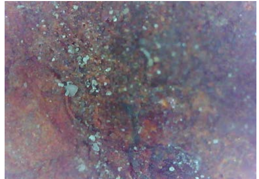
Resim 3.341. Taşkınpaşa Camii minberi niteliksiz onarım detay fotoğrafı 3 (a) Fotoğraf makinesi çekimi (b) Optik Mikroskopta x50 büyüklükte detay görüntüsü (c) Optik Mikroskopta x200 büyüklükte detay görüntüsü.
