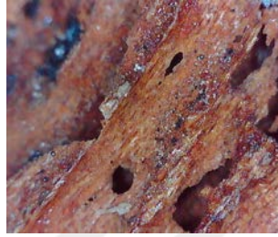
Resim 3.329. Taşkınpaşa Camii minberi böceklenme ve böcek uçuş delikleri detay fotoğrafı 11 (a) Fotoğraf makinesi çekimi (b) Optik Mikroskopta x50 büyüklükte detay görüntüsü (c, d) Optik Mikroskopta x200 büyüklükte detay görüntüsü.
