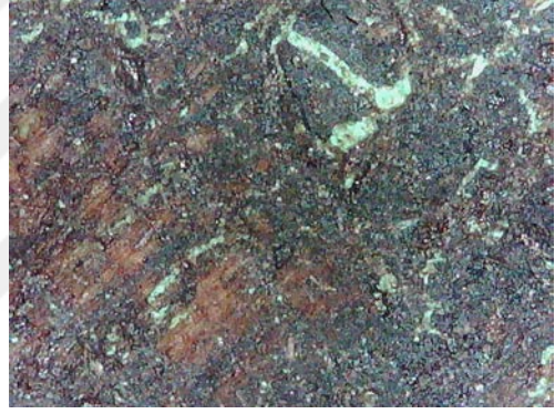
Resim 3.489. Şeyh Bahşi Mescidi vaaz kürsüsü tabakalaşma ve yüzeyden ayrılma detay fotoğrafı 1. (a) Fotoğraf makinesi çekimi b) Optik Mikroskopta x50 büyüklükte tabaka detay görüntüsü b) Optik Mikroskopta x200 büyüklükte tabaka detay görüntüsü.
