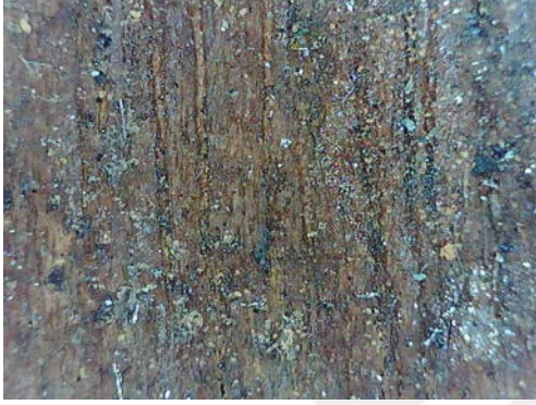
Resim 3.294. Taşkınpaşa Camii minberi yüzey birikintileri, toz ve kir / lekelenme detay fotoğrafı 2 (a) Fotoğraf makinesi çekimi (b) Optik Mikroskopta x50 büyüklükte detay görüntüsü (c) Optik Mikroskopta x200 büyüklükte detay görüntüsü.
