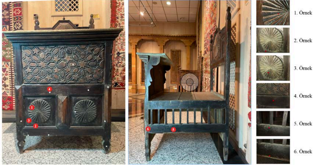
Resim 3.550. Gazanfer Ağa Camii vaaz kürsüsü portable XRF analiz noktaları.
