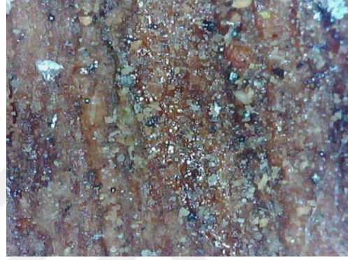
Resim 3.294. Taşkınpaşa Camii minberi yüzey birikintileri, toz ve kir / lekelenme detay fotoğrafı 2 (a) Fotoğraf makinesi çekimi (b) Optik Mikroskopta x50 büyüklükte detay görüntüsü (c) Optik Mikroskopta x200 büyüklükte detay görüntüsü.
