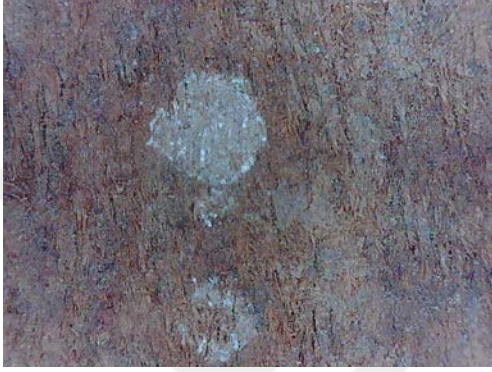
Resim 3.296. Taşkınpaşa Camii minberi yüzey birikintileri, toz ve kir / lekelenme detay fotoğrafı 4 (a) Fotoğraf makinesi çekimi (b) Optik Mikroskopta x50 büyüklükte detay görüntüsü (c) Optik Mikroskopta x200 büyüklükte detay görüntüsü.
