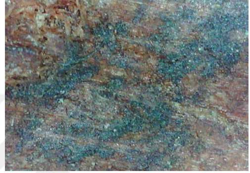
Resim 3.280. Taşkınpaşa Camii minberi renk değişim detay fotoğrafı 1 (a) Fotoğraf makinesi çekimi (b) Optik Mikroskopta x50 büyüklükte detay görüntüsü (c) Optik Mikroskopta x200 büyüklükte detay görüntüsü.
