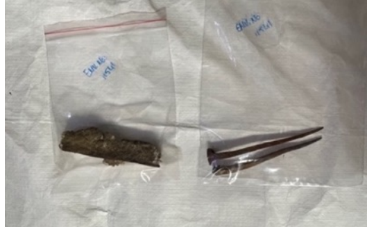
Resim 3.2. Taşkınpaşa Camii mihrabı metal çivi Mikro XRF numune örneği fotoğrafı.
