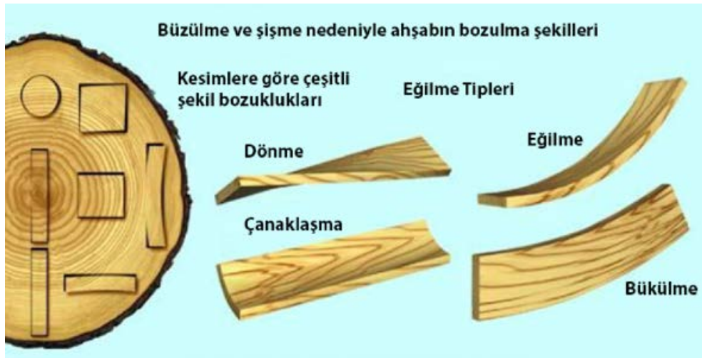
Şekil 2.2. Ahşap malzemede görülen şekil bozuklukları tipleri.
