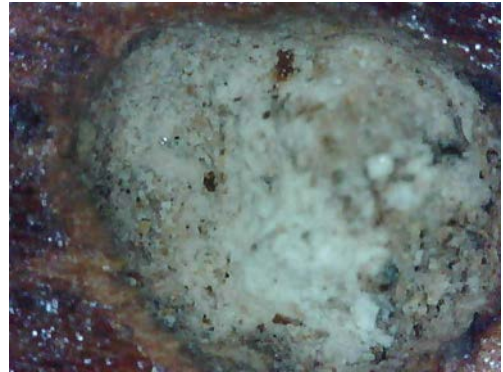
Resim 3.525. Şeyh Bahşi Mescidi vaaz kürsüsü yüzeyinde böcek uçuş delikleri detayı 1. (a) Fotoğraf makinesi çekimi b) Optik Mikroskopta x50 büyüklükte tabaka detay görüntüsü b) Optik Mikroskopta x200 büyüklükte tabaka detay görüntüsü.
