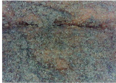
Resim 3.306. Taşkınpaşa Camii minberi yüzey birikintileri, toz ve kir / lekelenme detay fotoğrafı 14 (a) Fotoğraf makinesi çekimi (b) Optik Mikroskopta x50 büyüklükte detay görüntüsü (c) Optik Mikroskopta x200 büyüklükte detay görüntüsü.
