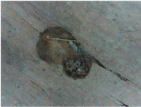
Resim 3.326. Taşkınpaşa Camii minberi böceklenme ve böcek uçuş delikleri detay fotoğrafı 8 (a) Fotoğraf makinesi çekimi (b) Optik Mikroskopta x50 büyüklükte detay görüntüsü (c) Optik Mikroskopta x200 büyüklükte detay görüntüsü.
