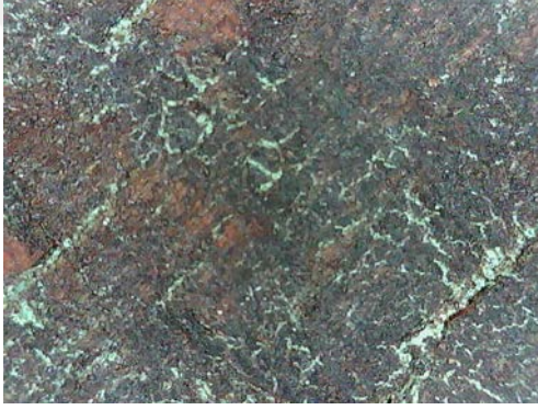
Resim 3.489. Şeyh Bahşi Mescidi vaaz kürsüsü tabakalaşma ve yüzeyden ayrılma detay fotoğrafı 1. (a) Fotoğraf makinesi çekimi b) Optik Mikroskopta x50 büyüklükte tabaka detay görüntüsü b) Optik Mikroskopta x200 büyüklükte tabaka detay görüntüsü.
