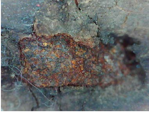
Resim 3.499. Şeyh Bahşi Mescidi vaaz kürsüsü korozyon görüntüsü 1. (a) Fotoğraf makinesi çekimi b) Optik Mikroskopta x50 büyüklükte tabaka detay görüntüsü b) Optik Mikroskopta x200 büyüklükte tabaka detay görüntüsü.
