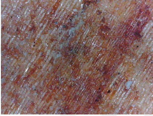
Resim 3.275. Taşkınpaşa Camii minberi erozyon detay fotoğrafı 3 (a) Fotoğraf makinesi çekimi (b) Optik Mikroskopta x50 büyüklükte detay görüntüsü (c) Optik Mikroskopta x200 büyüklükte detay görüntüsü.
