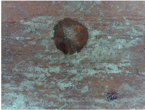
Resim 3.111. Taşkınıpaşa Camii mihrabı böcek uçuş delikleri detay fotoğrafı 2 (a) Fotoğraf makinesi çekimi (b, d, f) Optik Mikroskopta x50 büyüklükte detay görüntüsü (c, e, g) Optik Mikroskopta x200 büyüklükte detay görüntüsü.
