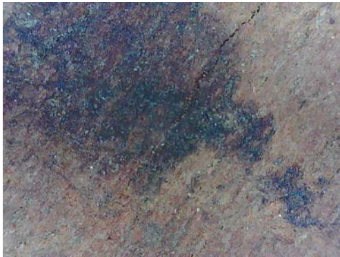
Resim 3.281. Taşkınpaşa Camii minberi renk değişim detay fotoğrafı 2 (a) Fotoğraf makinesi çekimi (b) Optik Mikroskopta x50 büyüklükte detay görüntüsü (c) Optik Mikroskopta x200 büyüklükte detay görüntüsü.
