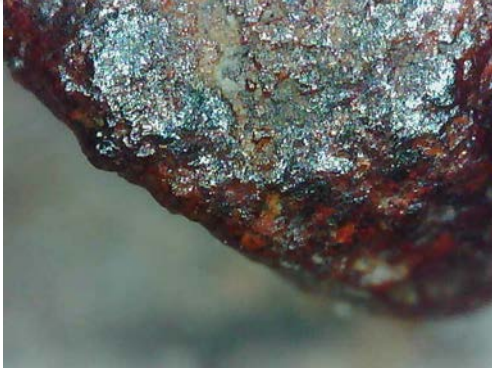
Resim 3.501. Şeyh Bahşi Mescidi vaaz kürsüsü korozyon görüntüsü 3. (a) Fotoğraf makinesi çekimi b) Optik Mikroskopta x50 büyüklükte tabaka detay görüntüsü b) Optik Mikroskopta x200 büyüklükte tabaka detay görüntüsü.
