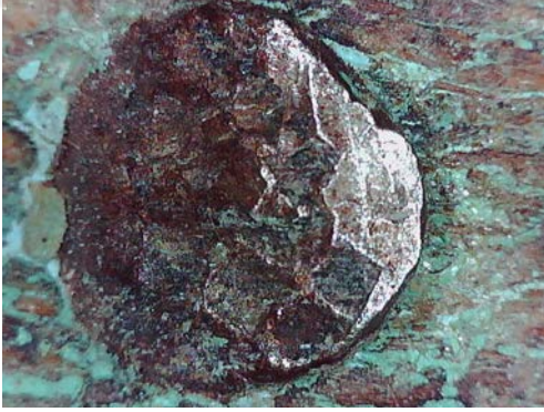
Resim 3.626. Gazanfer Ağa Camii vaaz kürsüsü ayak kısmı ahşap direklerde kullanılan metal çivilerde korozyon bozulma örneği ve detayı. (a) Fotoğraf makinesi çekimi b) Optik Mikroskopta x50 büyüklükte tabaka detay görüntüsü b) Optik Mikroskopta x200 büyüklükte tabaka detay görüntüsü.
