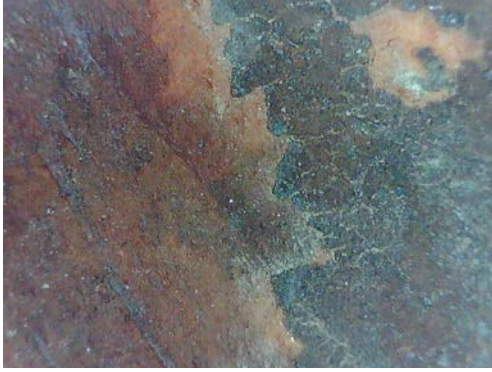
Resim 3.506. Şeyh Bahşı Mescidi vaaz kürsüsü renk değişimi renk değişimi örneği 5. (a) Fotoğraf makinesi çekimi b) Optik Mikroskopta x50 büyüklükte tabaka detay görüntüsü b) Optik Mikroskopta x200 büyüklükte tabaka detay görüntüsü.
