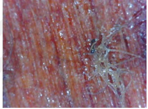
Resim 3.508. Şeyh Bahşi Mescidi vaaz kürsüsü renk değişimi örneği 7. (a) Fotoğraf makinesi çekimi b) Optik Mikroskopta x50 büyüklükte tabaka detay görüntüsü b) Optik Mikroskopta x200 büyüklükte tabaka detay görüntüsü.
