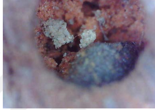
Resim 3.321. Taşkınpaşa Camii minberi böceklenme ve böcek uçuş delikleri detay fotoğrafı 3 (a) Fotoğraf makinesi çekimi (b) Optik Mikroskopta x50 büyüklükte detay görüntüsü (c) Optik Mikroskopta x200 büyüklükte detay görüntüsü.
