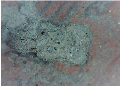
Resim 3.308. Taşkınpaşa Camii minberi yüzey birikintileri, toz ve kir / lekelenme detay fotoğrafı 16 (a) Fotoğraf makinesi çekimi (b) Optik Mikroskopta x50 büyüklükte detay görüntüsü (c) Optik Mikroskopta x200 büyüklükte detay görüntüsü.
