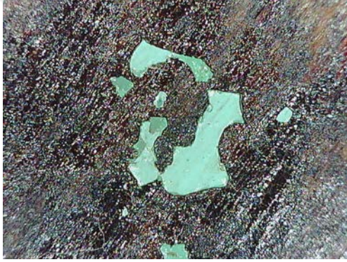
Resim 3.610. Gazanfer Ağa Camii vaaz kürsüsü tabakalaşma ve yüzeyden ayrılma detay fotoğrafı 8. (a) Fotoğraf makinesi çekimi b) Optik Mikroskopta x50 büyüklükte tabaka detay görüntüsü b) Optik Mikroskopta x200 büyüklükte tabaka detay görüntüsü.
