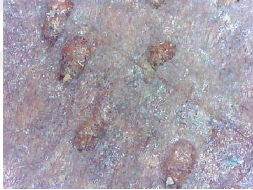
Resim 3.302. Taşkınpaşa Camii minberi yüzey birikintileri, toz ve kir / lekelenme detay fotoğrafı 10 (a) Fotoğraf makinesi çekimi (b, d) Optik Mikroskopta x50 büyüklükte detay görüntüsü (c, e) Optik Mikroskopta x200 büyüklükte detay görüntüsü.
