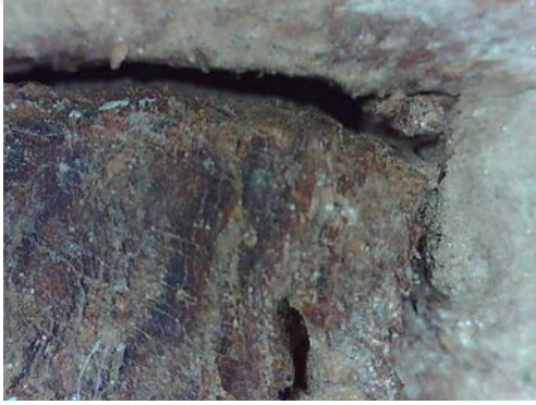
Resim 3.518. Şeyh Bahşi Mescidi vaaz kürsüsü birleşim elemanları yüzey birikinti örneği 1. (a) Fotoğraf makinesi çekimi b) Optik Mikroskopta x50 büyüklükte tabaka detay görüntüsü b) Optik Mikroskopta x200 büyüklükte tabaka detay görüntüsü.
