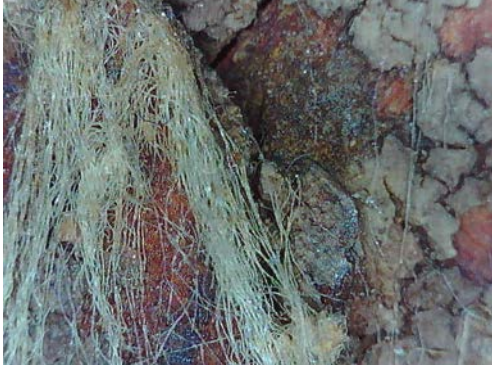
Resim 3.519. Şeyh Bahşi Mescidi vaaz kürsüsü birleşim elemanı yüzey birikinti örneği 2. (a) Fotoğraf makinesi çekimi b) Optik Mikroskopta x50 büyüklükte tabaka detay görüntüsü b) Optik Mikroskopta x200 büyüklükte tabaka detay görüntüsü.
