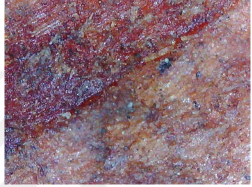
Resim 3.275. Taşkınpaşa Camii minberi erozyon detay fotoğrafı 3 (a) Fotoğraf makinesi çekimi (b) Optik Mikroskopta x50 büyüklükte detay görüntüsü (c) Optik Mikroskopta x200 büyüklükte detay görüntüsü.
