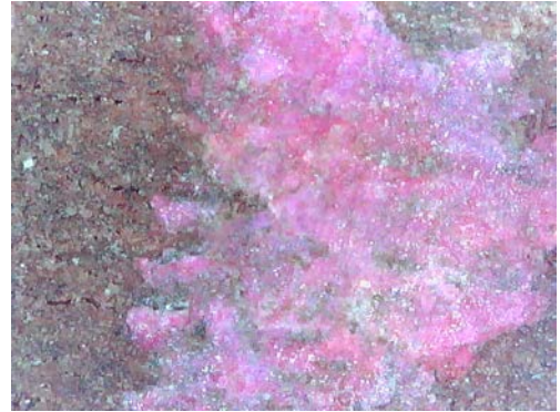
Resim 3.301. Taşkınpaşa Camii minberi yüzey birikintileri, toz ve kir / lekelenme detay fotoğrafı 9 (a) Fotoğraf makinesi çekimi (b) Optik Mikroskopta x50 büyüklükte detay görüntüsü (c) Optik Mikroskopta x200 büyüklükte detay görüntüsü.
