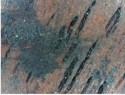
Resim 3.633. Gazanfer Ağa Camii vaaz kürsüsü ön korkuluk kısmı siyah tabaka üzerine toz ve kir bozulması örneği. (a) Fotoğraf makinesi çekimi b) Optik Mikroskopta x50 büyüklükte tabaka detay görüntüsü b) Optik Mikroskopta x200 büyüklükte tabaka detay görüntüsü.
