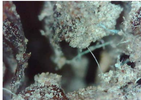
Resim 3.310. Taşkınpaşa Camii minberi yüzey birikintileri, toz ve kir / lekelenme detay fotoğrafı 18 (a) Fotoğraf makinesi çekimi (b) Optik Mikroskopta x50 büyüklükte detay görüntüsü (c) Optik Mikroskopta x200 büyüklükte detay görüntüsü.
