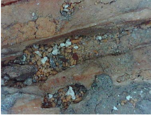
Resim 3.492. Şeyh Bahşi Mescidi vaaz kürsüsü sedir kısmında tabakalaşma ve yüzeyden ayrılma detay fotoğrafı 4. (a) Fotoğraf makinesi çekimi b) Optik Mikroskopta x50 büyüklükte tabaka detay görüntüsü b) Optik Mikroskopta x200 büyüklükte tabaka detay görüntüsü.
