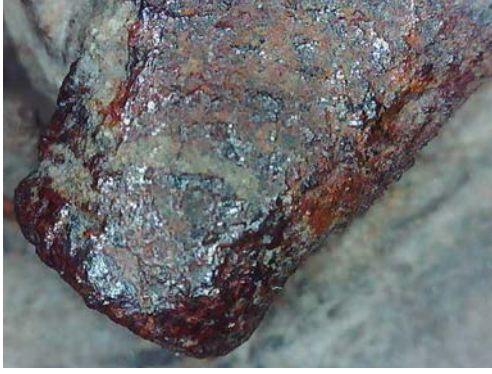
Resim 3.500. Şeyh Bahşı Mescidi vaaz kürsüsü korozyon görüntüsü 2. (a) Fotoğraf makinesi çekimi b) Optik Mikroskopta x50 büyüklükte tabaka detay görüntüsü b) Optik Mikroskopta x200 büyüklükte tabaka detay görüntüsü.
