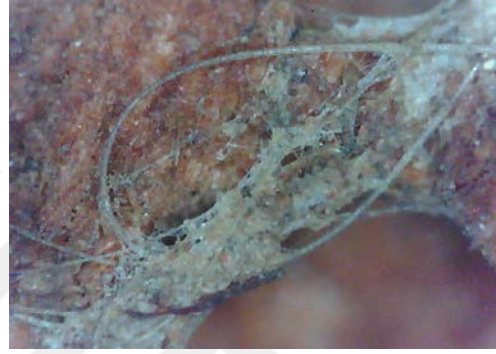
Resim 3.325. Taşkınpaşa Camii minberi böceklenme ve böcek uçuş delikleri detay fotoğrafı 7 (a) Fotoğraf makinesi çekimi (b) Optik Mikroskopta x50 büyüklükte detay görüntüsü (c) Optik Mikroskopta x200 büyüklükte detay görüntüsü.
