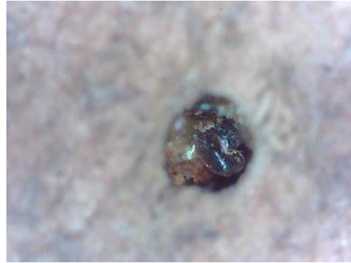
Resim 3.322. Taşkınpaşa Camii minberi böceklenme ve böcek uçuş delikleri detay fotoğrafı 4 (a) Fotoğraf makinesi çekimi (b) Optik Mikroskopta x50 büyüklükte detay görüntüsü (c) Optik Mikroskopta x200 büyüklükte detay görüntüsü.
