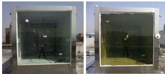
Şekil 2.15. Termokromik cam kullanım örneği (Anderson ve diğ., 2016 aktaran Yüksel Ayvaz, 2019)
