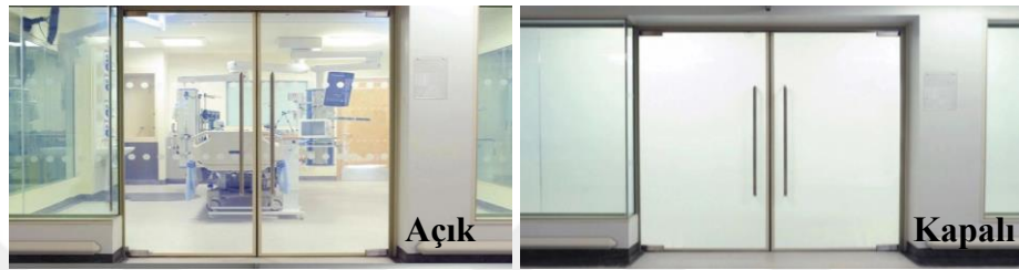
Şekil 2.8. Hastane cam ve kapısında sıvı kristal film kullanım örneği (URL-5)
