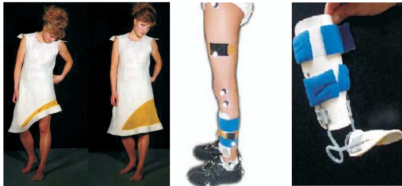
Şekil 2.1. Elbise ve protez bacak uygulamalarında şekil hafızalı alaşım kullanım örneği (Bedeloğlu, 2011)
