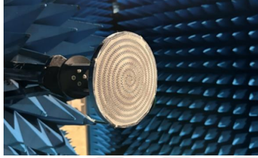
Şekil 3.17 Prototip anten ölçüm düzeneği
