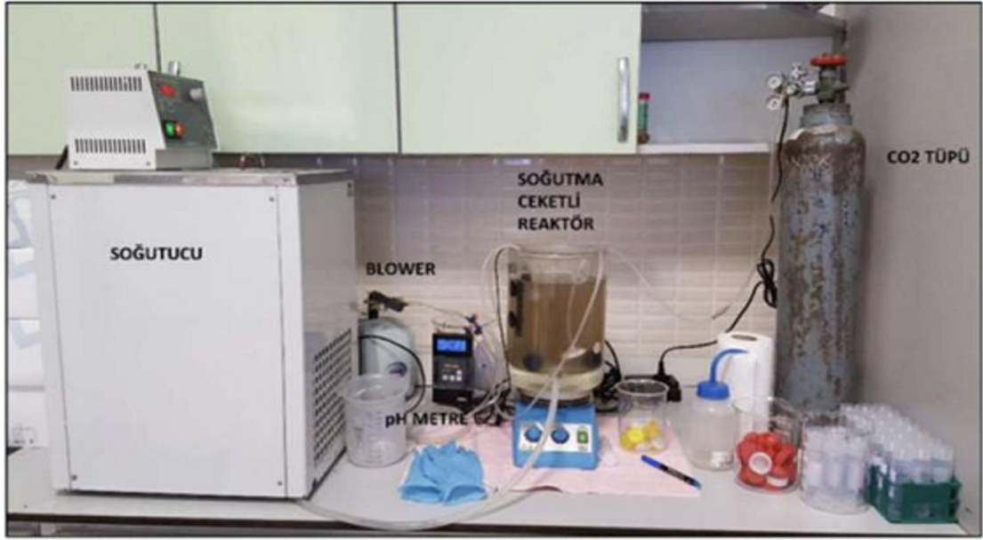
Şekil 2.3. Yüksek F/M nitrifikasyon deney düzeneği (İSKİ Ambarlı İBAAT).
